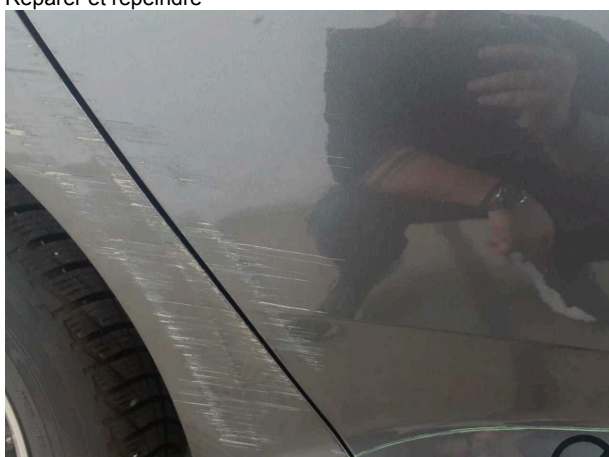
Domage #8: Porte ArD: Porte - Bosse, dommage peinture - Réparer et repeindre
