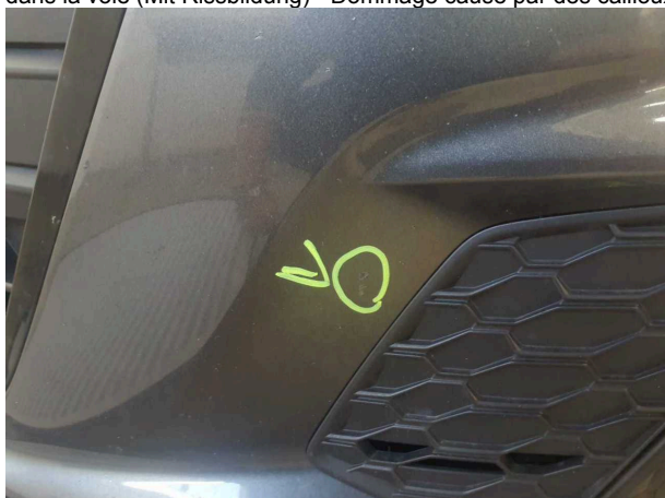
Domage #11: Pare-chocs avant: Pare-chocs avant - Déformé - Remplacer
