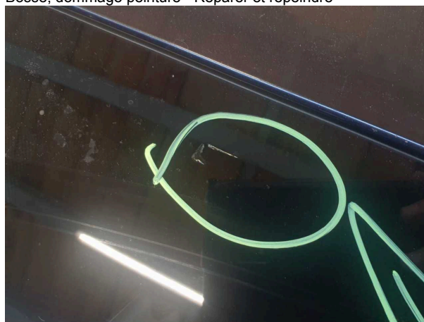
Domage #10: Vitrage: Pare-brise avec assistance au maintien dans la voie (Mit Rissbildung) - Dommage causé par
