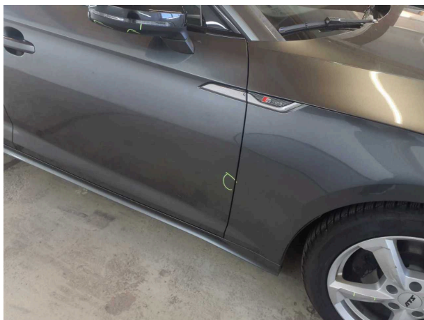
Domage #1: Porte AvD: Porte - bosse(s) - Bon travail de réparation
