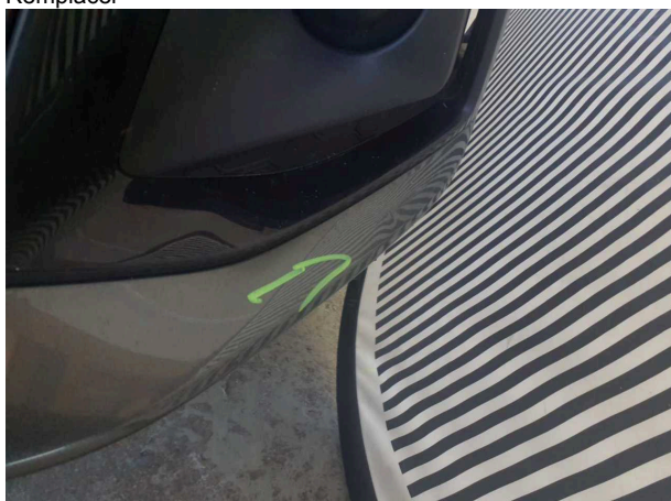
Domage #11: Pare-chocs avant: Pare-chocs avant - Déformé - Remplacer
