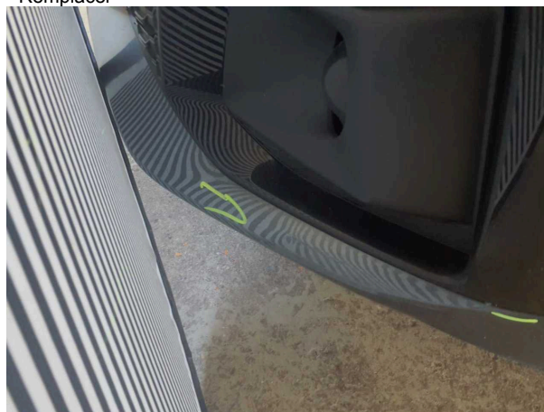
Domage #11: Pare-chocs avant: Pare-chocs avant - Déformé - Remplacer
