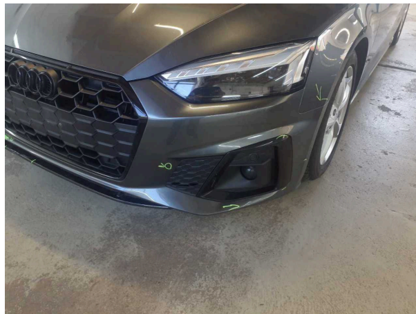
Domage #11: Pare-chocs avant: Pare-chocs avant - Déformé - Remplacer
