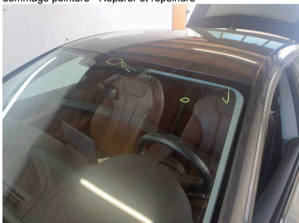
Domage #10: Vitrage: Pare-brise avec assistance au maintien dans la voie (Mit Rissbildung) - Dommage causé par des cailloux -
