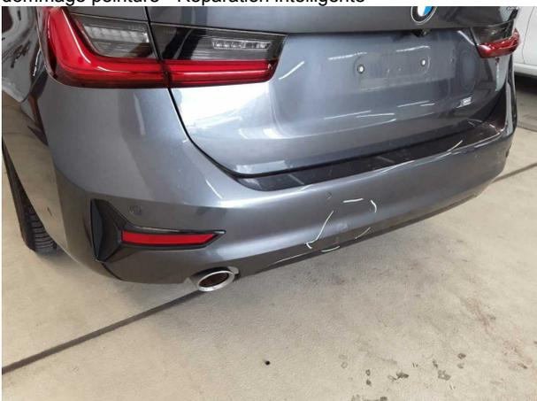
**Dommage #3:** Pare-chocs arrière: Pare-chocs arrière (Stark) - Erafilé - Remplacer
