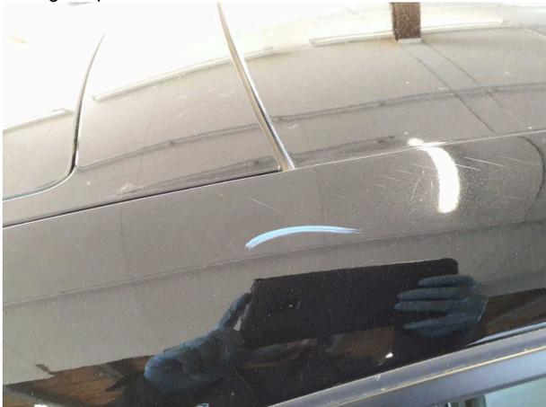
**Beschädigung #1:** Fahrzeugdach: Dachholm rechts - Kratzer - auslegen / polieren
