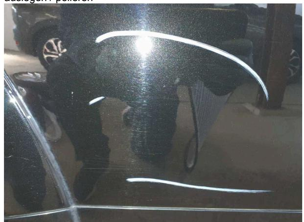
**Beschädigung #2:** Seitenwand rechts: Seitenwand - Kratzer - auslegen / polieren
