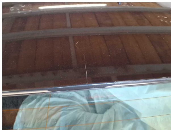
Beschädigung #2: Heckklappe/-tür: Heckspoiler - Kratzer - lackieren
