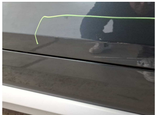
Beschädigung #4: Tür hinten rechts: Tür - Kratzer - lackieren
