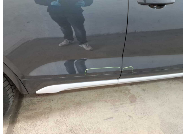
Beschädigung #4: Tür hinten rechts: Tür - Kratzer - lackieren
