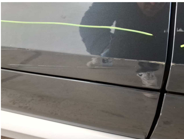
Beschädigung #4: Tür hinten rechts: Tür - Kratzer - lackieren
