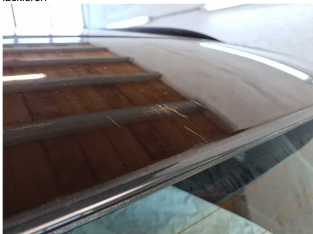
Beschädigung #2: Heckklappe/-tür: Heckspoiler - Kratzer - lackieren
