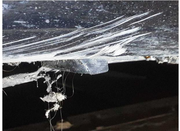
**Beschädigung #6:** Karosserie: Unterbodenverkleidung - lose - befunden ggf. instandsetzen
