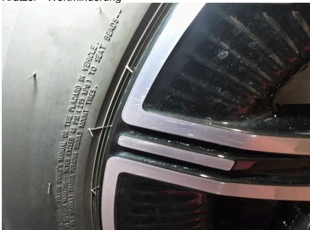
**Beschädigung #5:** Rad/Reifen: Leichtmetallfelge hinten rechts - Kratzer - Wertminderung
