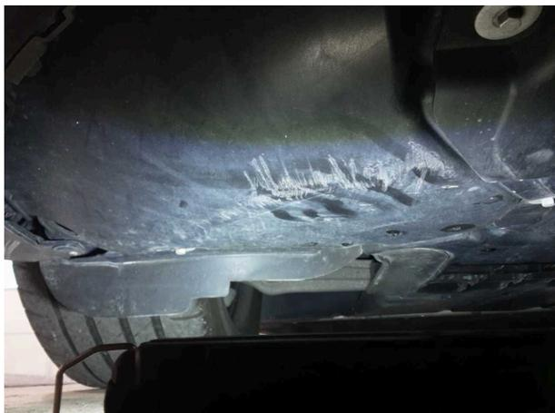
**Beschädigung #1:** Karosserie: Unterbodenverkleidung - Kratzer - erneuern
