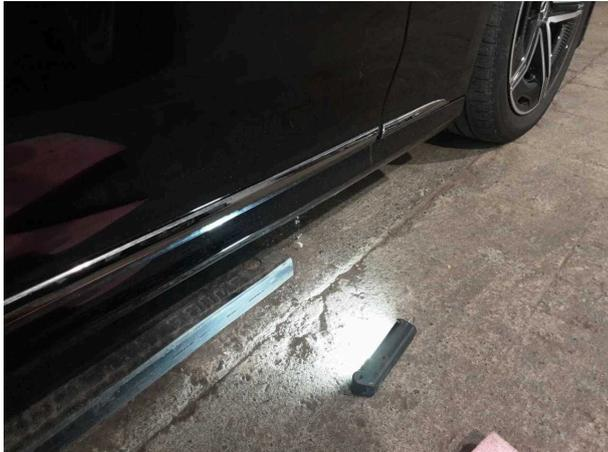
**Beschädigung #4:** Schweller rechts: Schweller - Kratzer - Smart Repair
