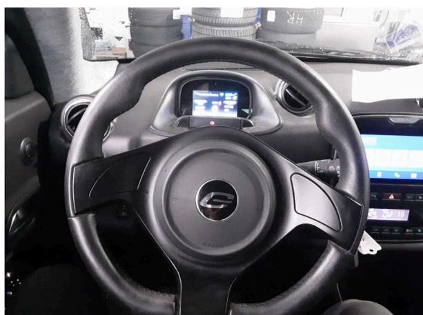
**Abbildung 9: Kombiinstrument**
