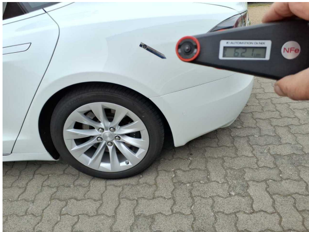
Nachlackierung 1: Seitenwand links
