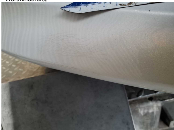
Beschädigung #2: Stossfänger vorn: Stossfänger vorn (verformt) - gebrochen / gerissen - erneuern
