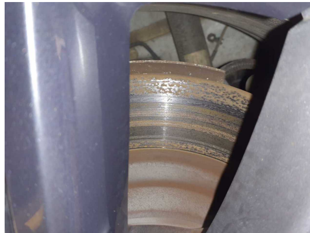
Beschädigung #1: Bremsanlage: Bremsscheiben hinten (Tragbild Mangelhaft) - Korrosion - erneuern
