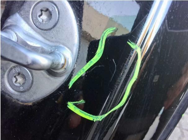
**Beschädigung #7:** Schweller links: Einstieg - Lackmangel - Smart Repair
