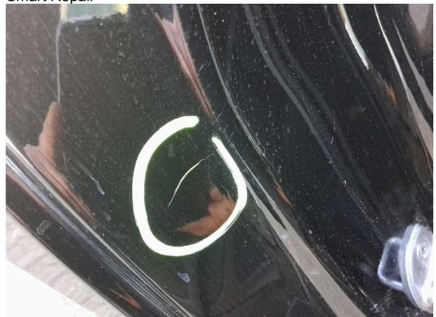
**Beschädigung #8:** Schweller rechts: Einstieg - Lackmangel - Smart Repair
