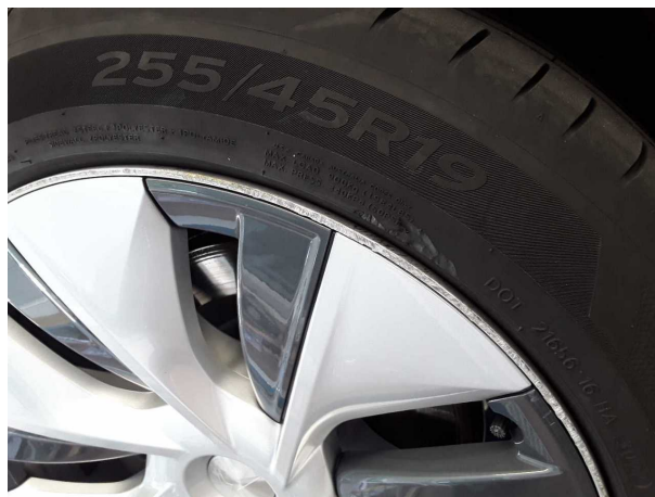
Beschädigung #4: Rad/Reifen: Reifen hinten rechts - beschädigt - erneuern
