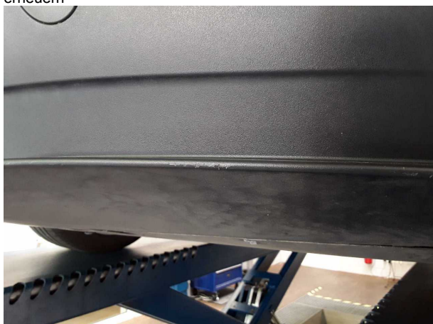
Beschädigung #5: Stossfänger hinten: Spoiler - verkratzt / verschürft - erneuern
