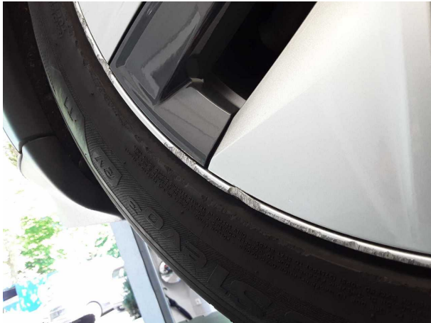
Beschädigung #6: Rad/Reifen: Leichtmetallfelge hinten rechts (Materialabtrag) - beschädigt - erneuern
