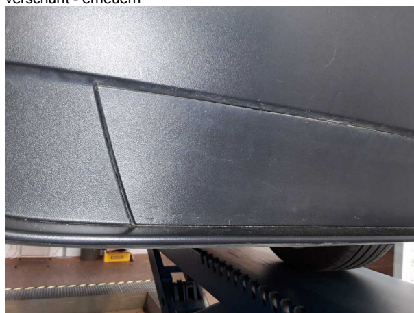
Beschädigung #5: Stossfänger hinten: Spoiler - verkratzt / verschürft - erneuern
