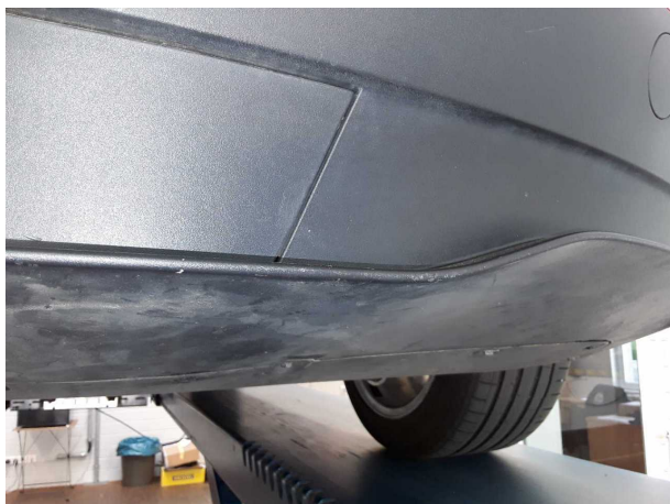
Beschädigung #5: Stossfänger hinten: Spoiler - verkratzt / verschürft - erneuern
