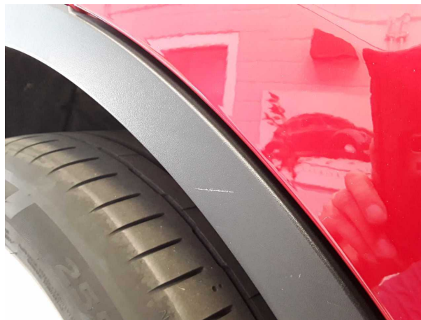
Beschädigung #1: Seitenwand rechts: Radlauf (Blende) - Kratze... Smart Repair
