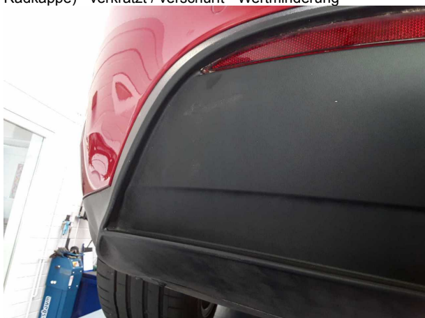
Beschädigung #5: Stossfänger hinten: Spoiler - verkratzt / verschürft - erneuern
