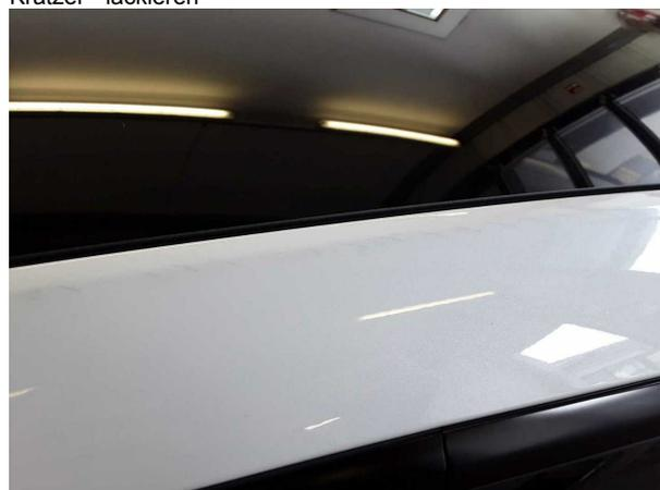
**Beschädigung #14:** Fahrzeugdach: Dachholm links (und Beklebt) - Kratzer - lackieren
