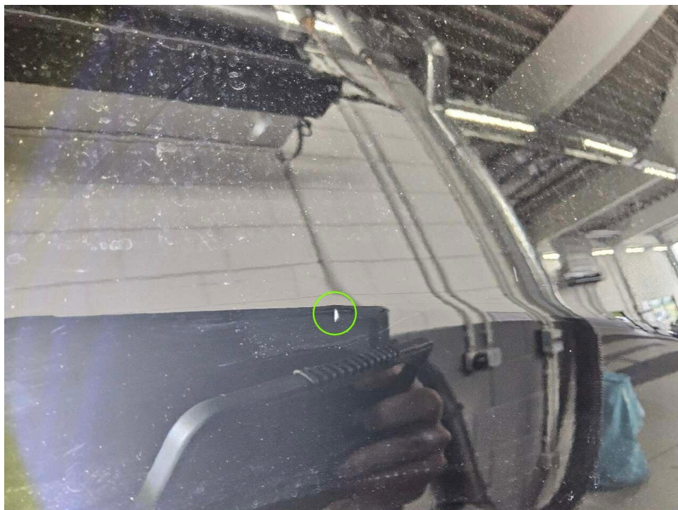
Bild 20 : Seitenwand hinten links leichte delle mit kleinem lackschaden
