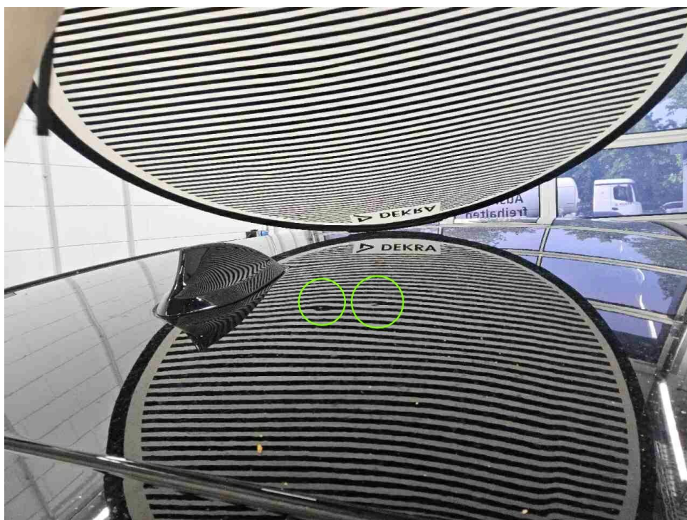
Bild 18 : Dach mehrfach eingedellt
