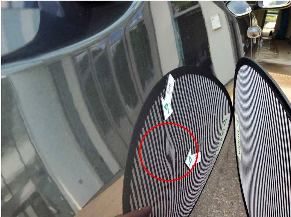
Bild 19 : Tür hinten rechts Delle
