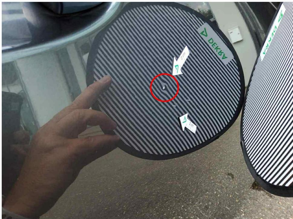
Bild 17 : Tür vorne rechts Delle mit Lackbeschädigung
