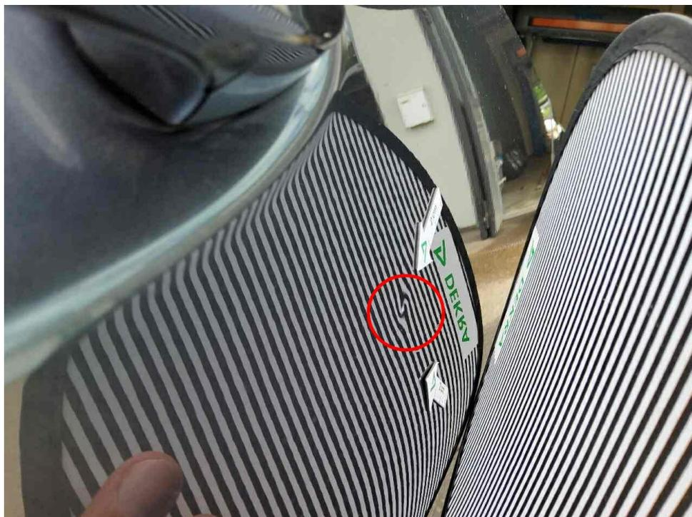
Bild 18 : Tür vorne rechts Delle mit Lackbeschädigung
