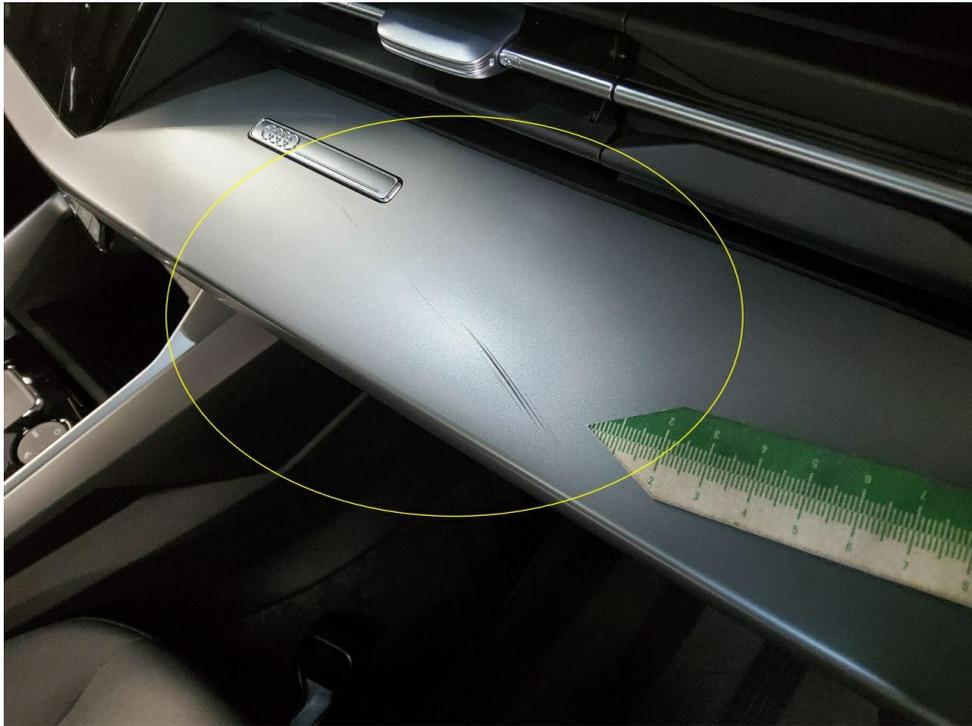
Bild 15 : Armaturenbrett Blende rechts Kratzer
