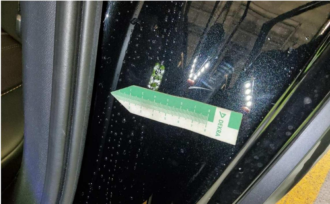
Bild 15 : Einstieg hinten links verschrammt
