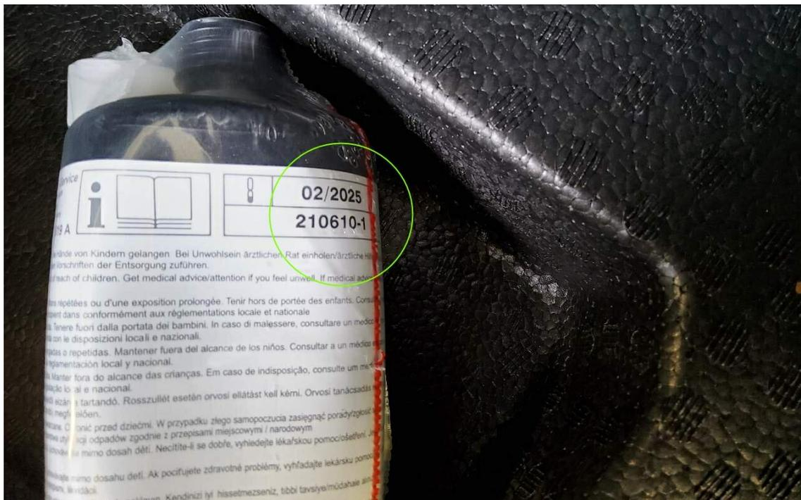
Bild 13 : Reifenfüllflasche abgelaufen
