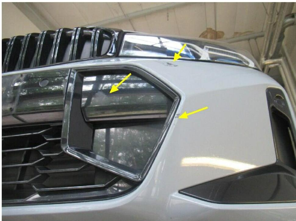
Bild 14 : Schaden vorne links Stoßfänger
