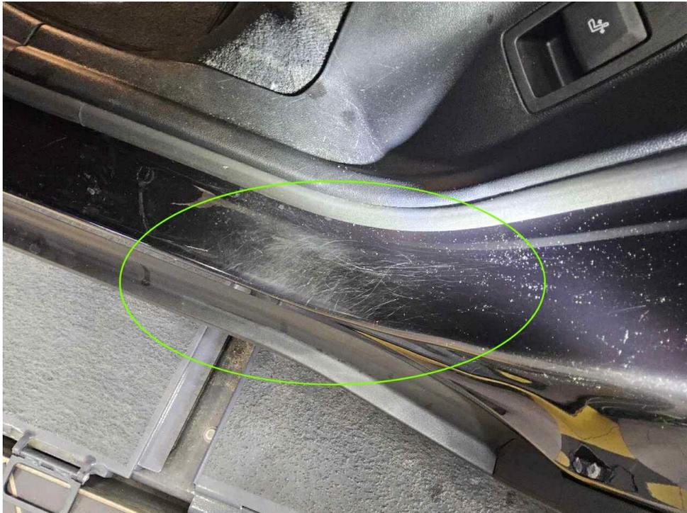
Bild 19 : Türeinstieg hinten links verkratzt und eingedellt
