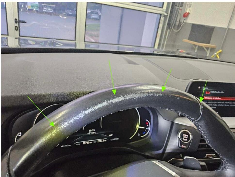
Bild 20 : Lenkradkrantz Ablösung
