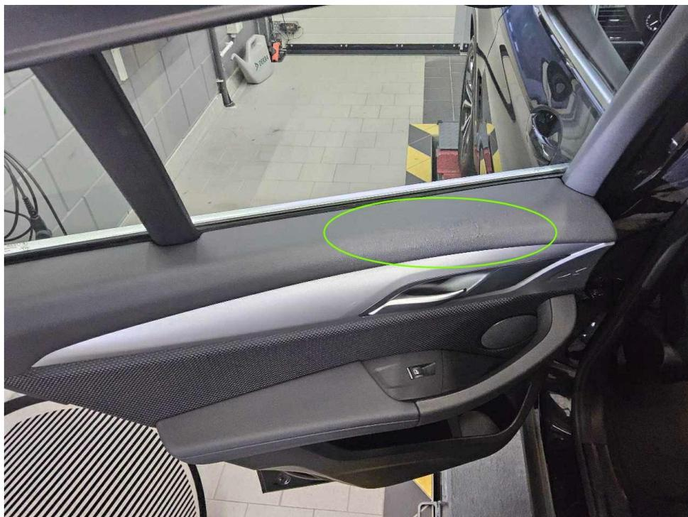
Bild 16 : Türverkleidung hinten links Polster oben verschrammt
