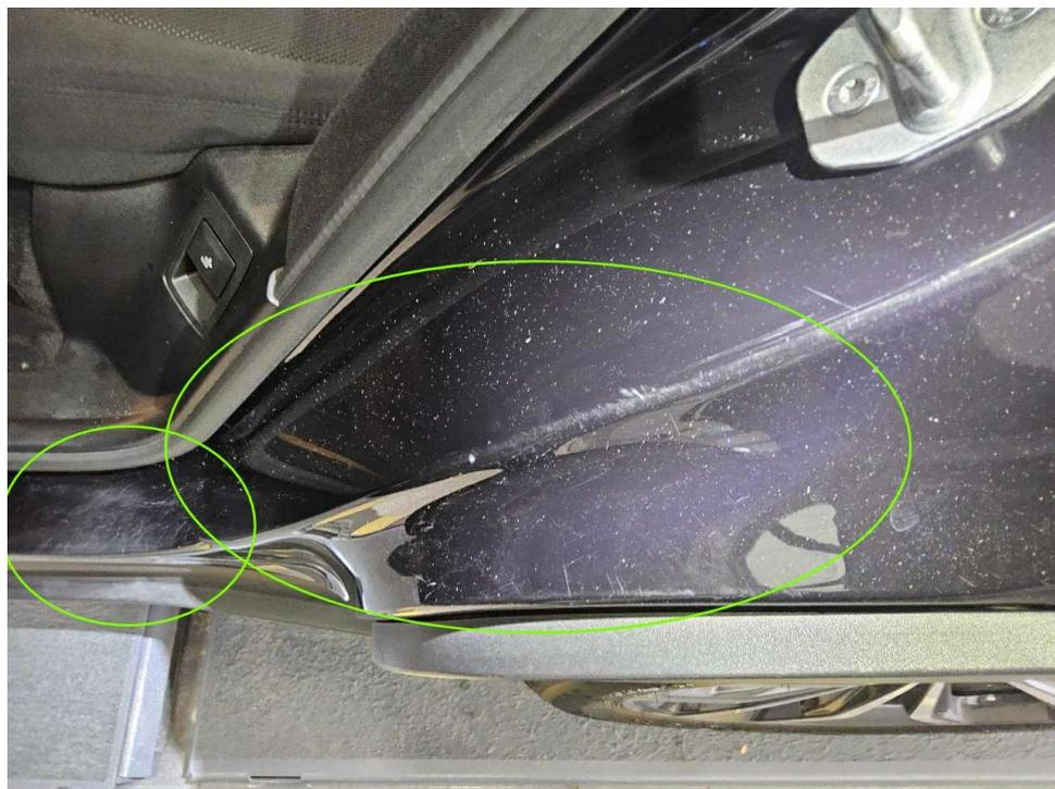
Bild 18 : Türeinstieg hinten links verkratzt und eingedellt
