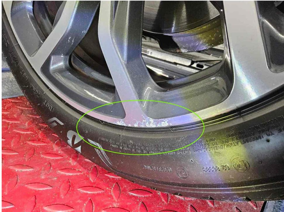
Bild 23 : Felge glanzgedreht vorne rechts verschrammt
