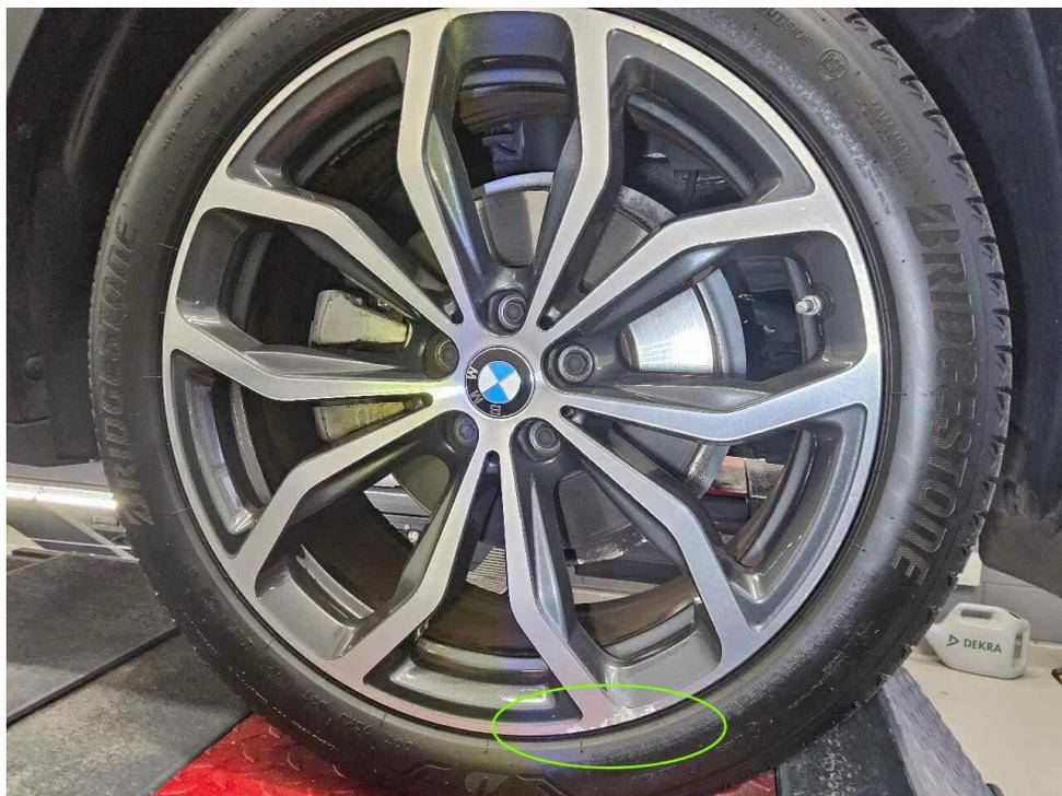
Bild 24 : Felge glanzgedreht vorne rechts verschrammt
