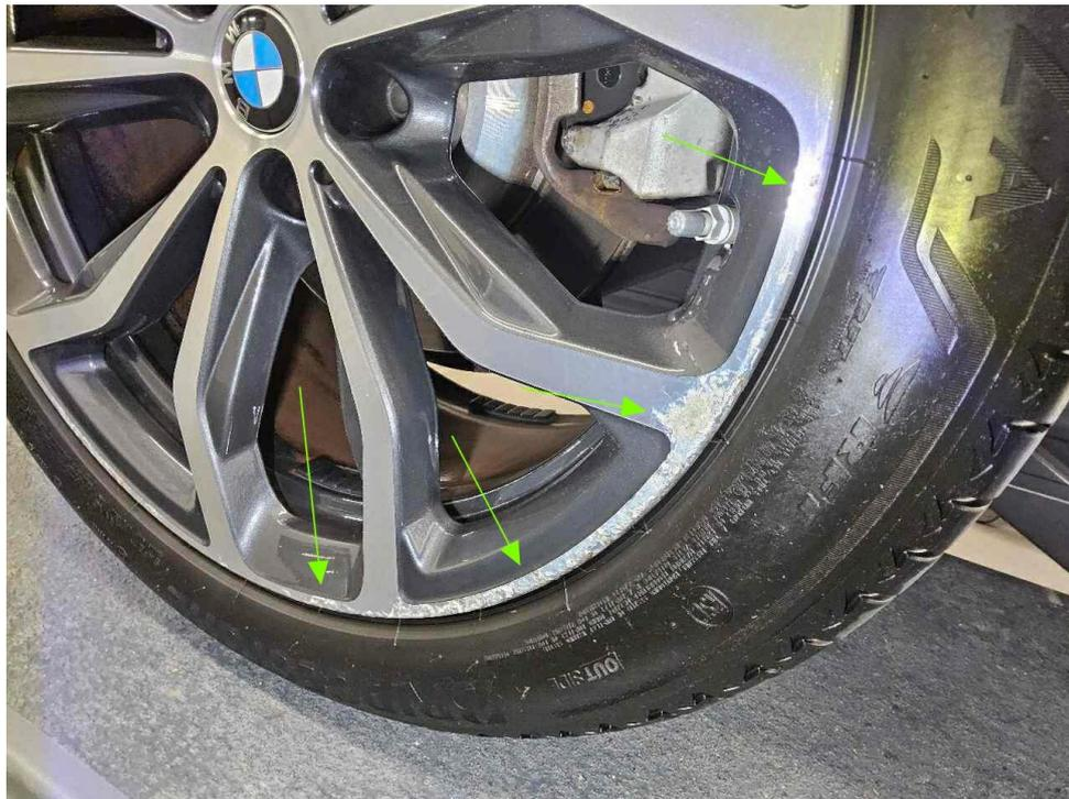
Bild 25 : Felge glanzgedreht hinten rechts verschrammt
