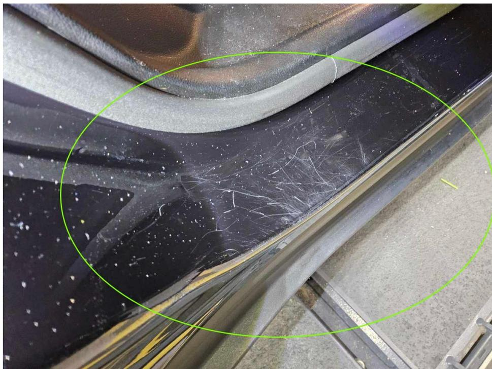
Bild 14 : Türeinstieg hinten rechts verkratzt und eingedellt
