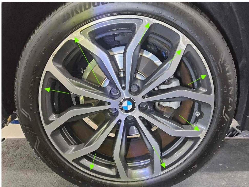
Bild 26 : Felge glanzgedreht hinten rechts verschrammt
