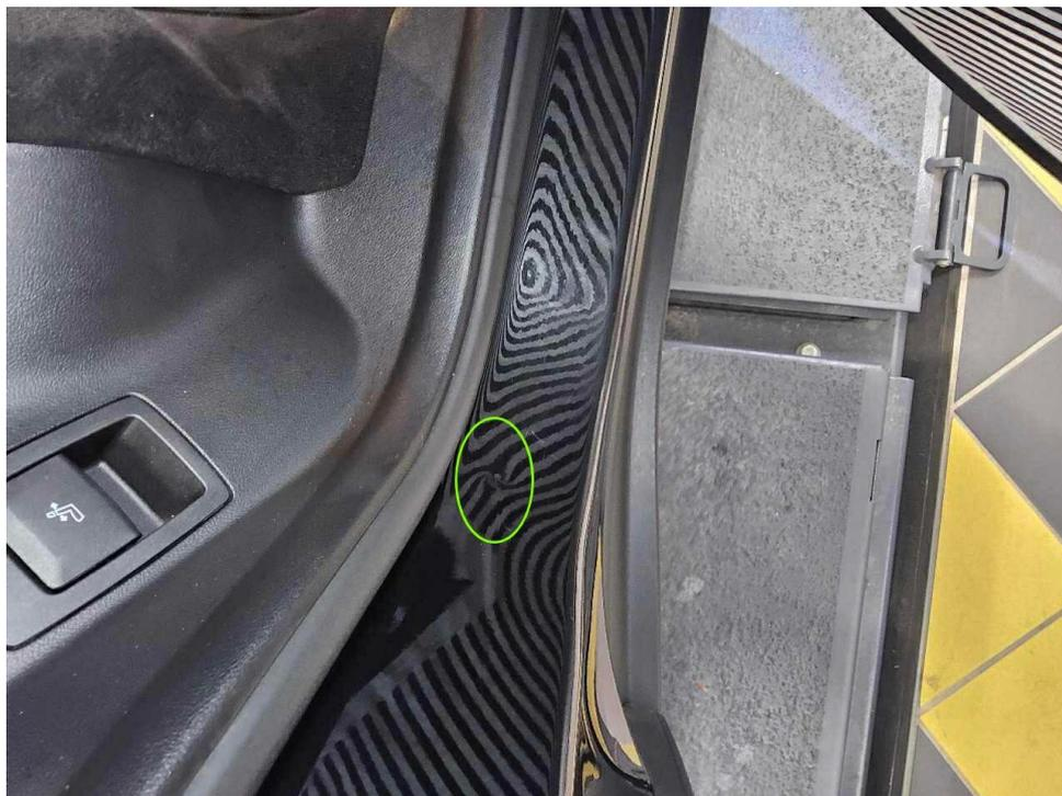
Bild 13 : Türeinstieg hinten rechts verkratzt und eingedellt
