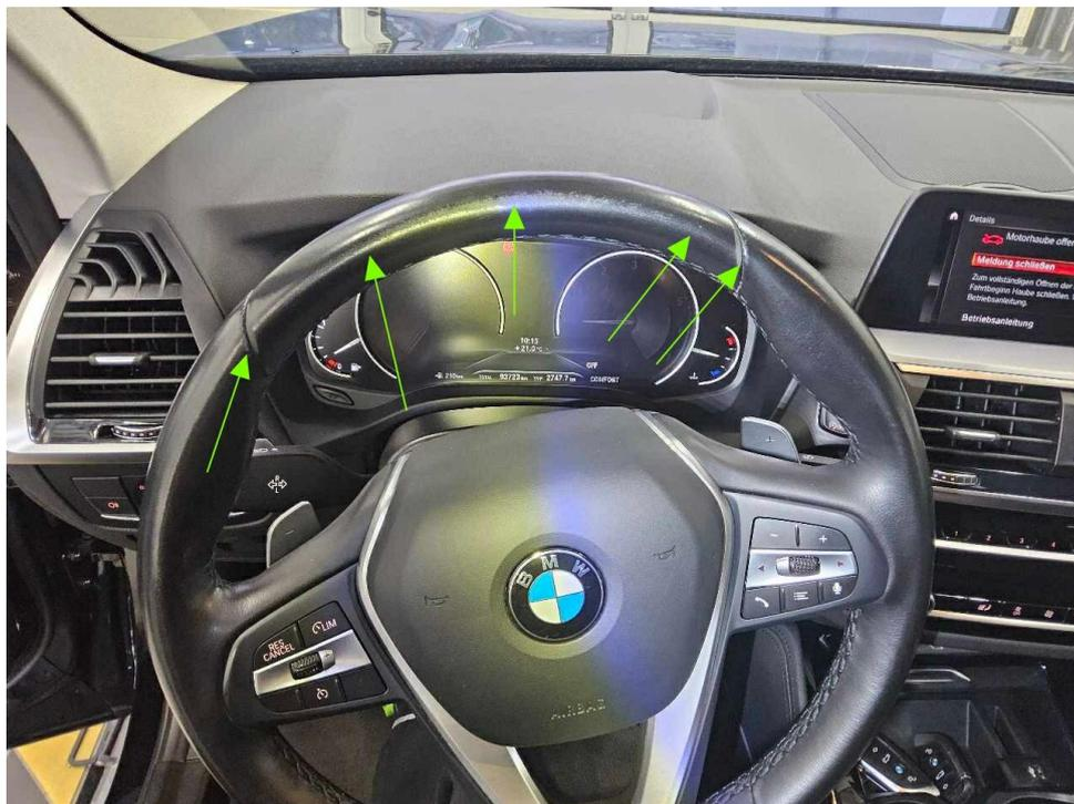
Bild 21 : Lenkradkrantz Ablösung
