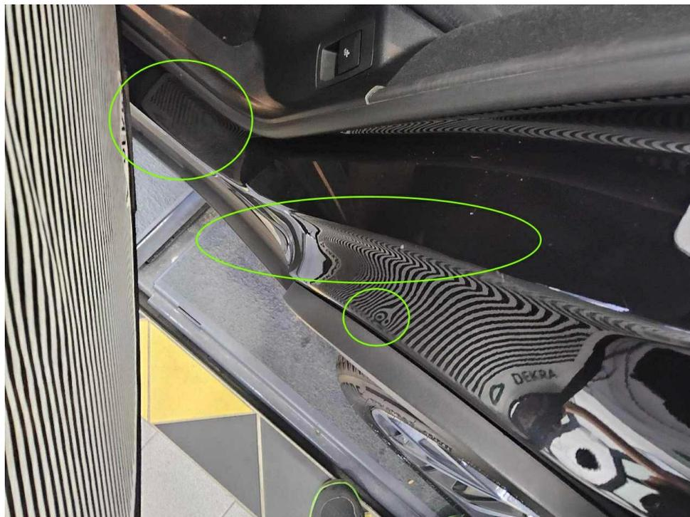
Bild 17 : Türeinstieg hinten links verkratzt und eingedellt
