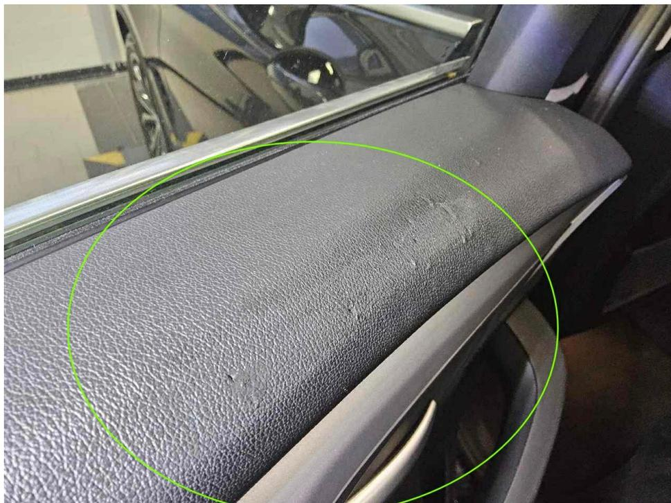
Bild 15 : Türverkleidung hinten links Polster oben verschrammt
