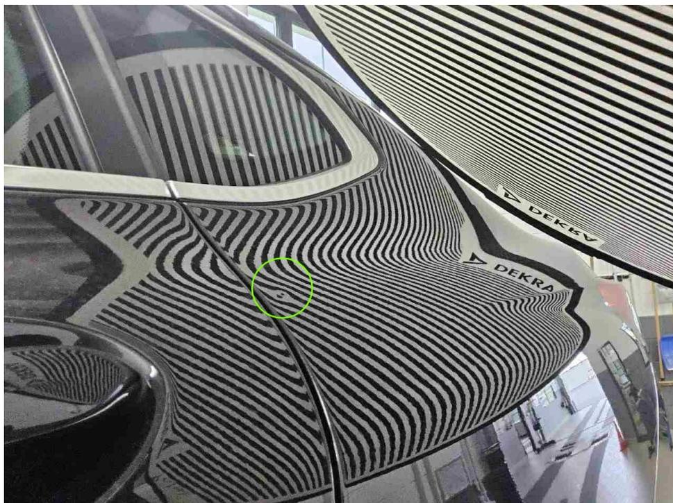
Bild 22 : Seitenwand hinten links eingedellt
