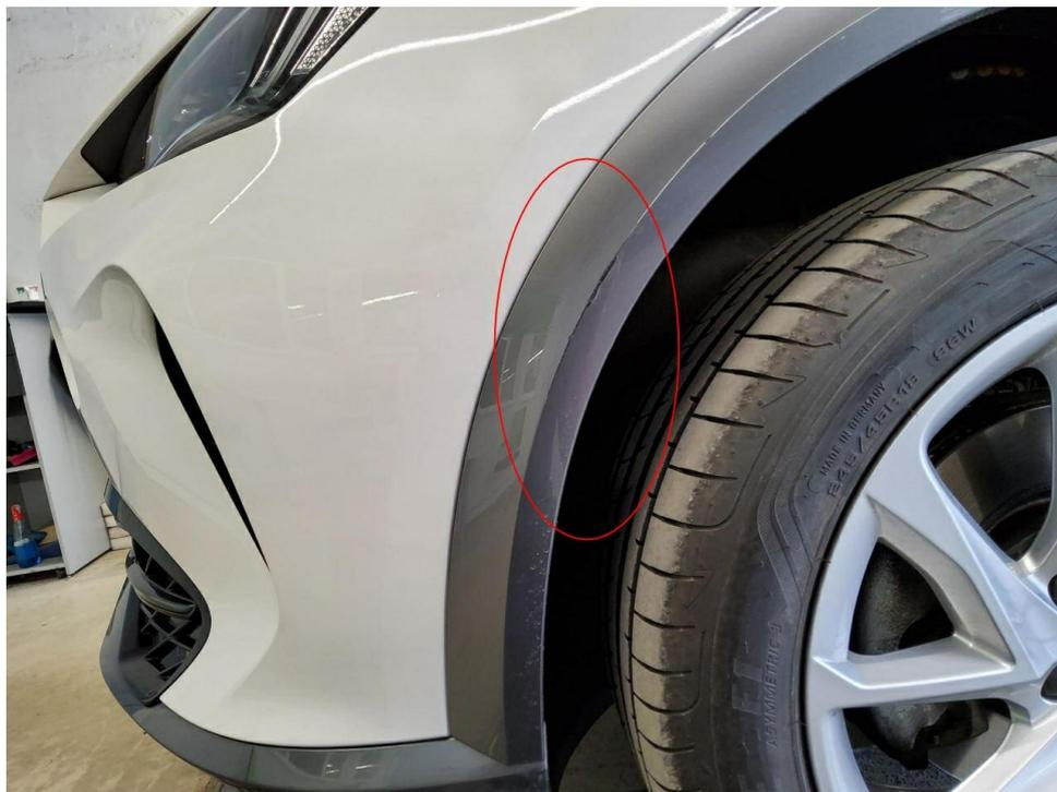
Bild 15 : Stoßfänger vorne Rammschutzleiste links Lackierung, verschrammt, lackieren mit Lackaufbau
