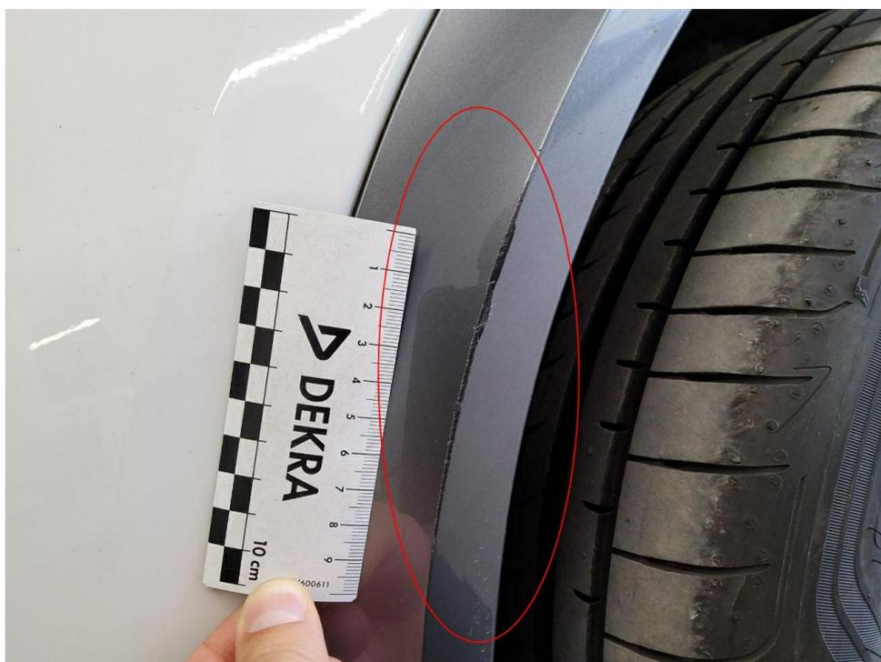
Bild 16 : Stoßfänger vorne Rammschutzleiste links Lackierung, verschrammt, lackieren mit Lackaufbau
