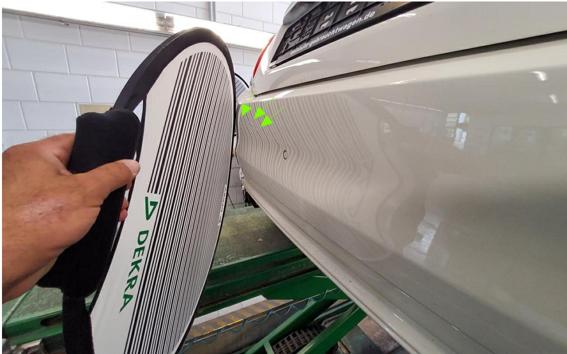
Bild 19 : Stoßfänger hinten Druckstellen
