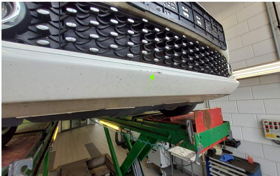
Bild 21 : Stoßfänger vorne verschrammt
