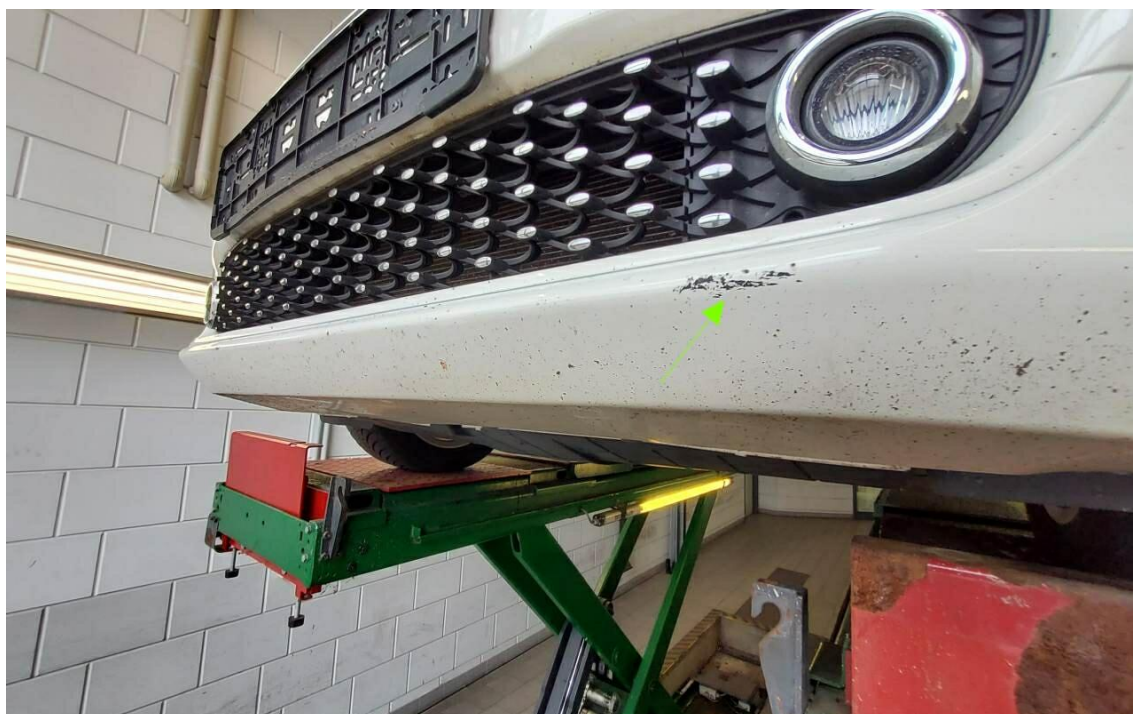
Bild 22 : Stoßfänger vorne verschrammt
