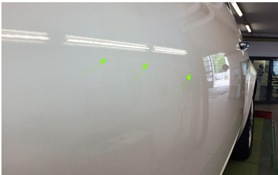
Bild 18 : Tür vorne links Kratzer (Vandalismus)
