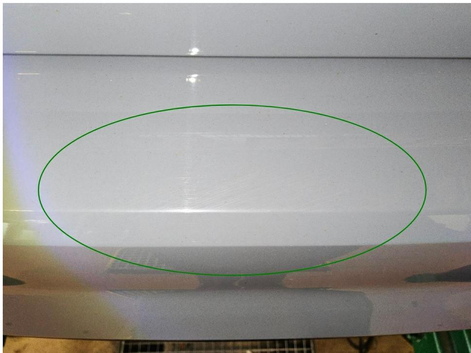
Bild 21 : Stoßfänger Ladekante verschrammt
