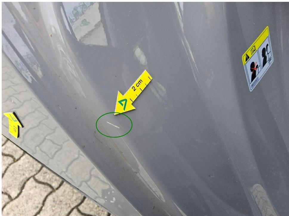
Bild 17 : Einstieg hinten rechts verschrammt
