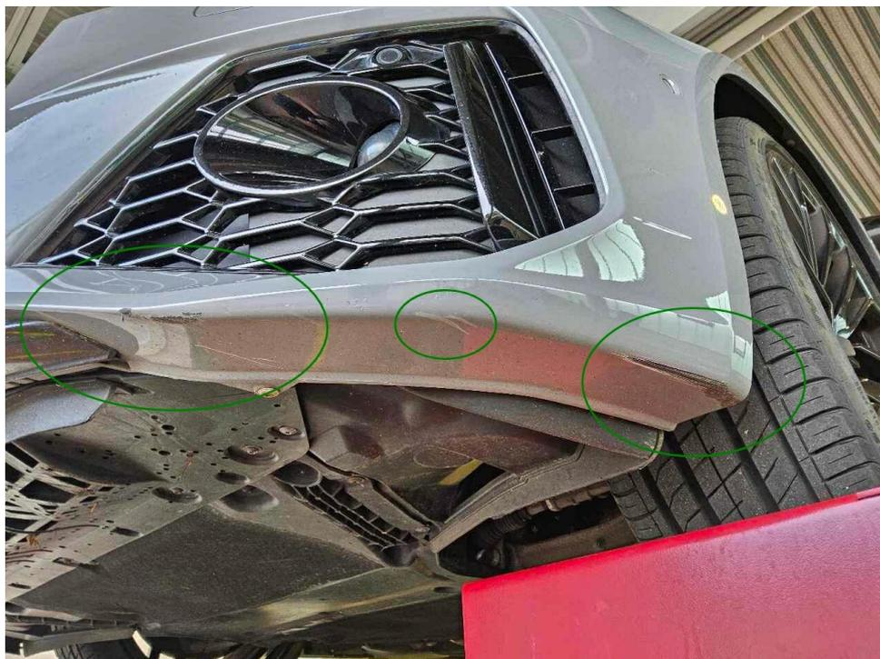
Bild 22 : Stoßfänger vorne unten verschrammt
