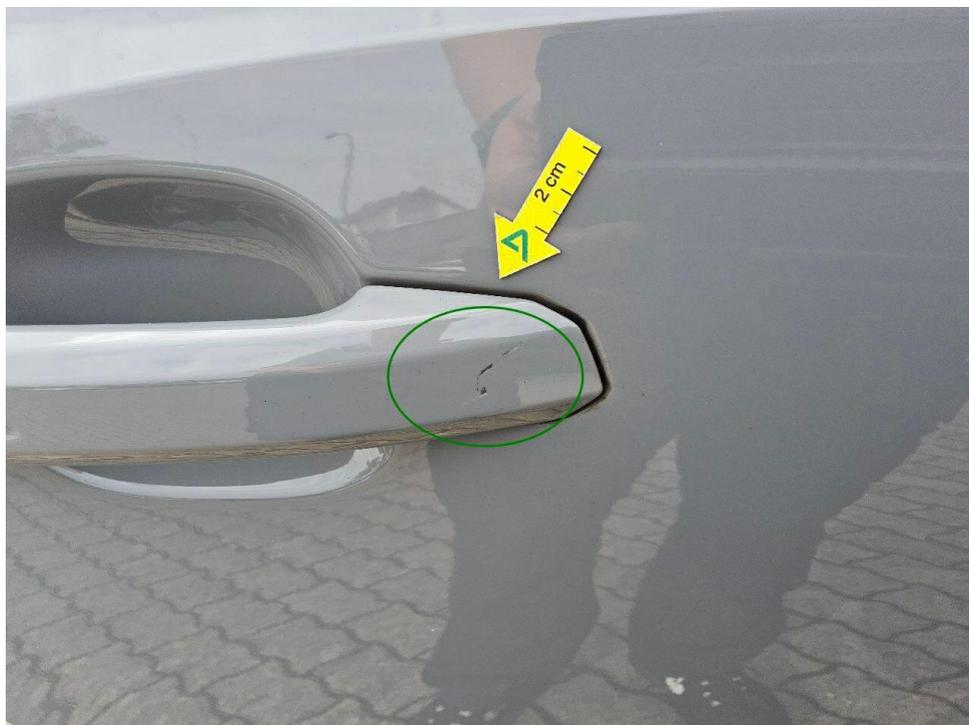
Bild 16 : Türgriff hinten rechts verschrammt
