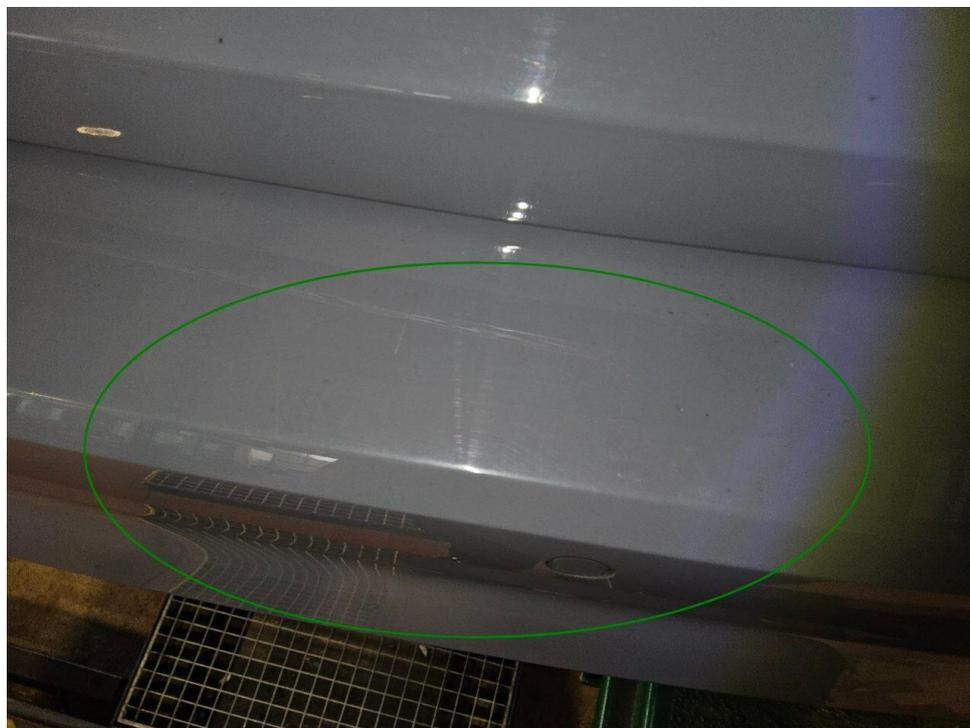
Bild 20 : Stoßfänger Ladekante verschrammt
