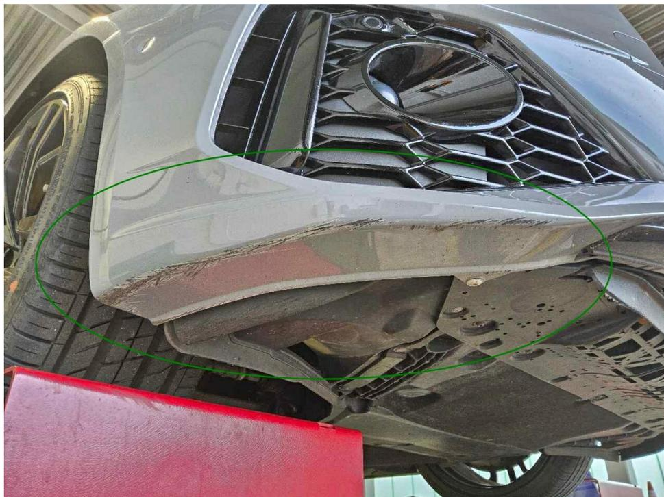
Bild 23 : Stoßfänger vorne unten verschrammt
