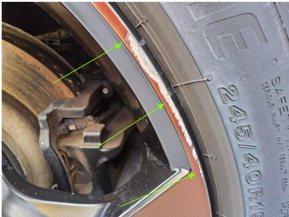
Bild 37 : Felge glanzgedreht BiColor hinten rechts mehrfach verschrammt mit Materialabtrag
