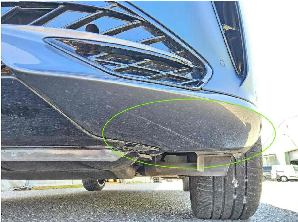
Bild 29 : Frontspoilerecke links glanzlackiert geprägt, verschrammt und Ecke deformiert
