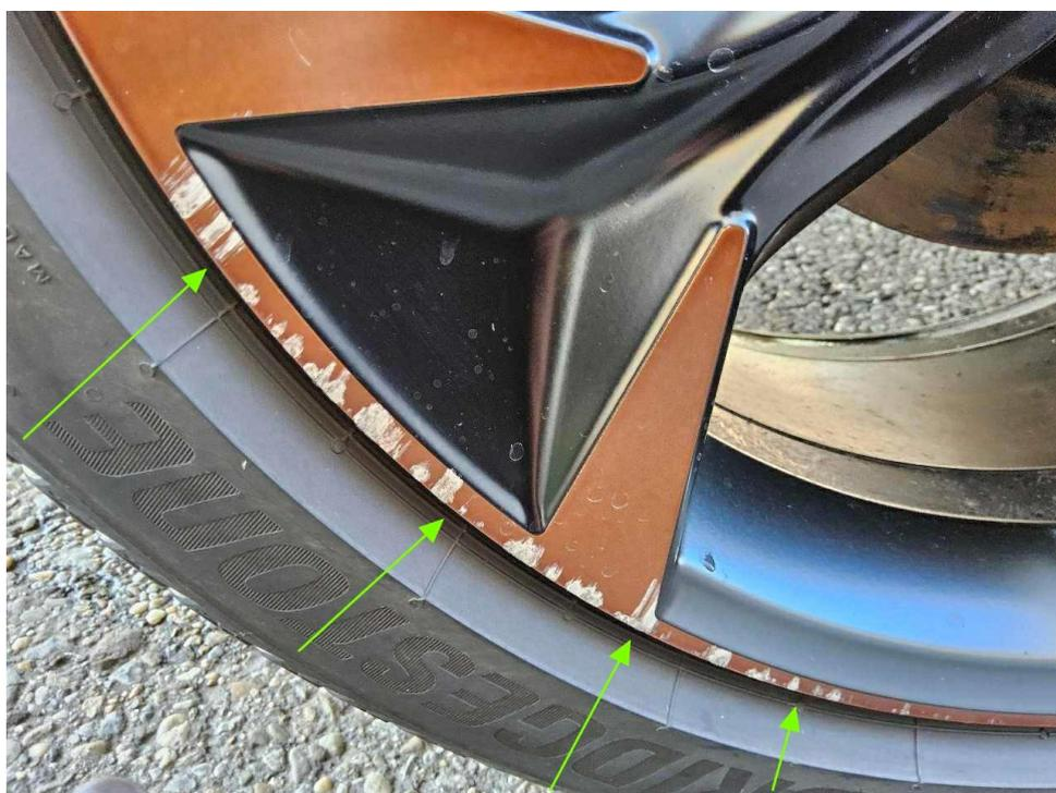
Bild 36 : Felge glanzgedreht BiColor hinten rechts mehrfach verschrammt mit Materialabtrag
