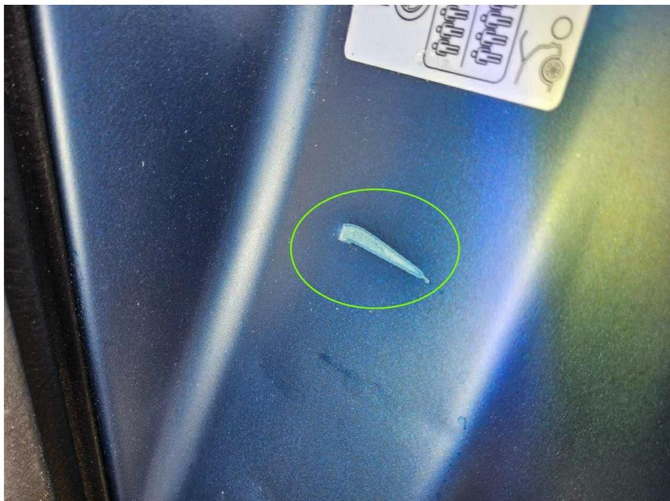
Bild 26 : Türeinstieg vorne links Lackbeschädigung und 5-fach eingedellt - Minderwert
