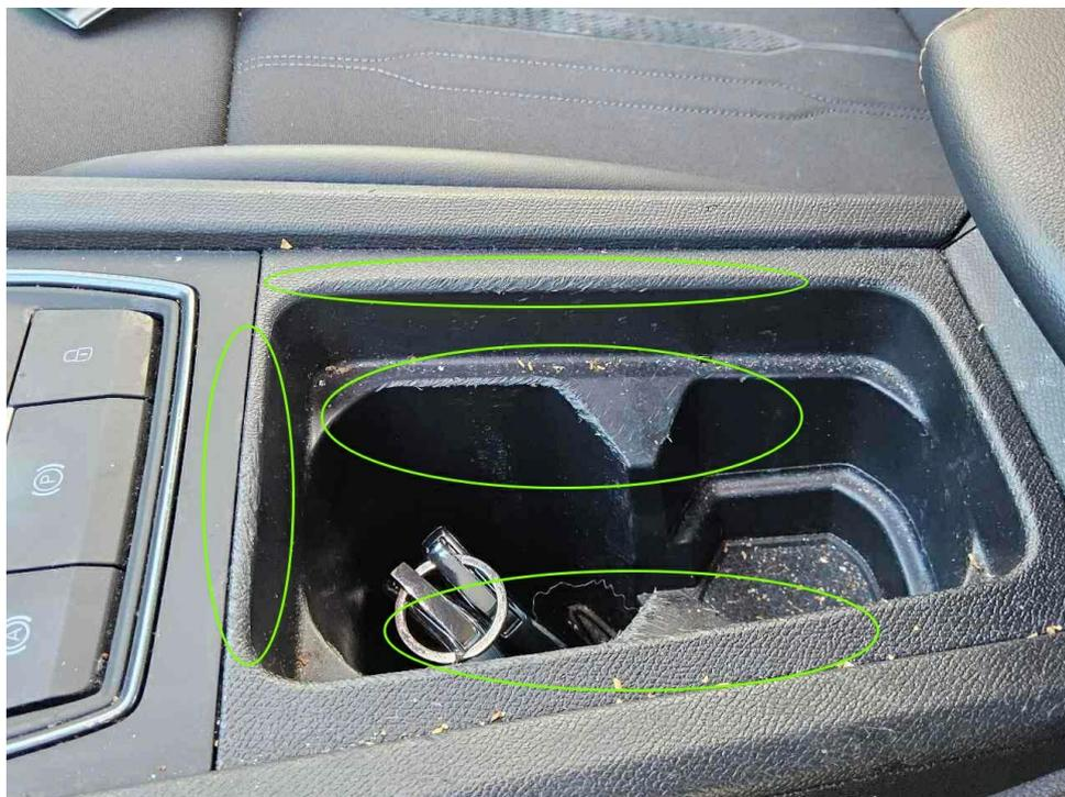
Bild 20 : Mittelkonsole Ablagefach mehrfach verschrammt
