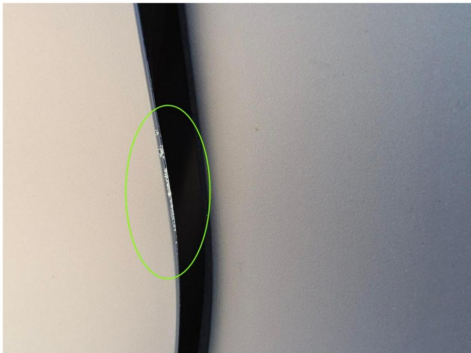
Bild 27 : Tür vorne links Türkante verschrammt, auslegen
