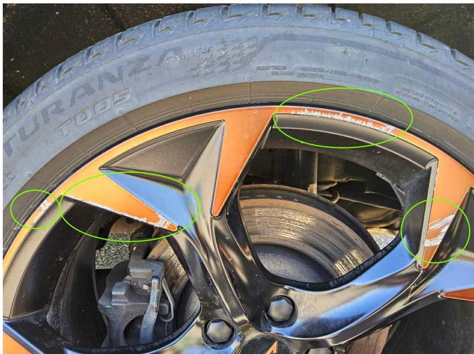
Bild 32 : Felge glanzgedreht BiColor hinten links mehrfach verschrammt mit Materialabtrag
