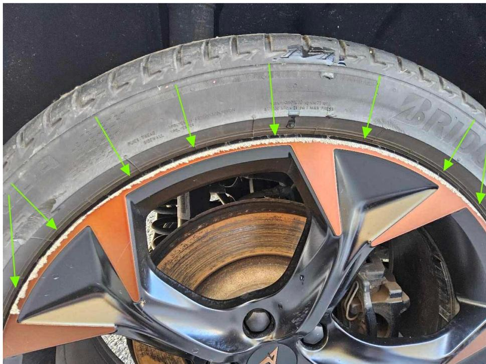
Bild 35 : Felge glanzgedreht BiColor hinten rechts mehrfach verschrammt mit Materialabtrag
