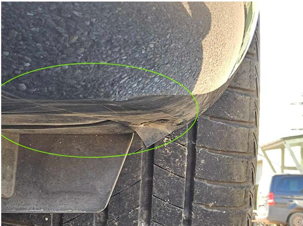
Bild 30 : Frontspoilerecke links glanzlackiert geprägt, verschrammt und Ecke deformiert
