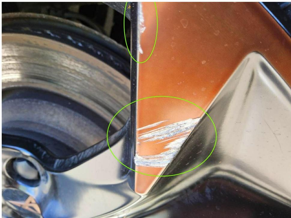
Bild 33 : Felge glanzgedreht BiColor hinten links mehrfach verschrammt mit Materialabtrag
