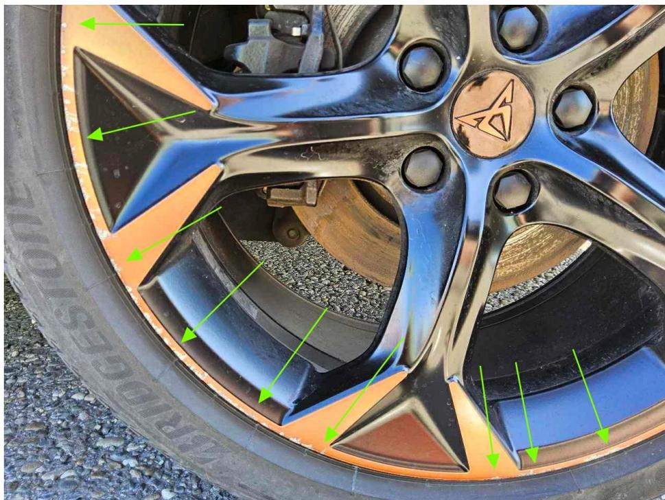
Bild 34 : Felge glanzgedreht BiColor hinten links mehrfach verschrammt mit Materialabtrag
