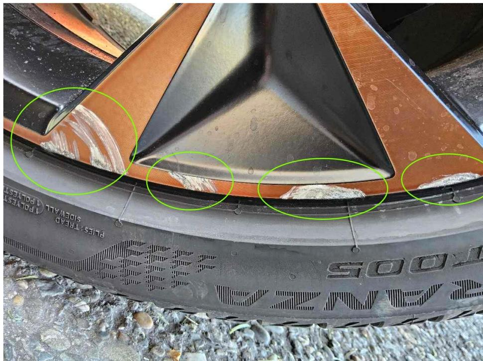
Bild 39 : Felge glanzgedreht BiColor vorne rechts mehrfach verschrammt mit Materialabtrag
