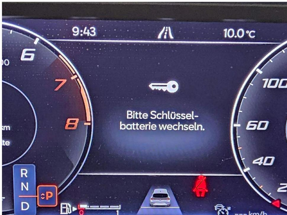
Bild 17 : T 1. Funk-Fahrzeugschlüssel ohne Funktion, Batterie leer
