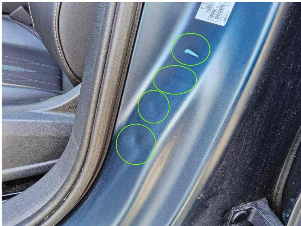
Bild 25 : Türeinstieg vorne links Lackbeschädigung und 5-fach eingedellt - Minderwert
