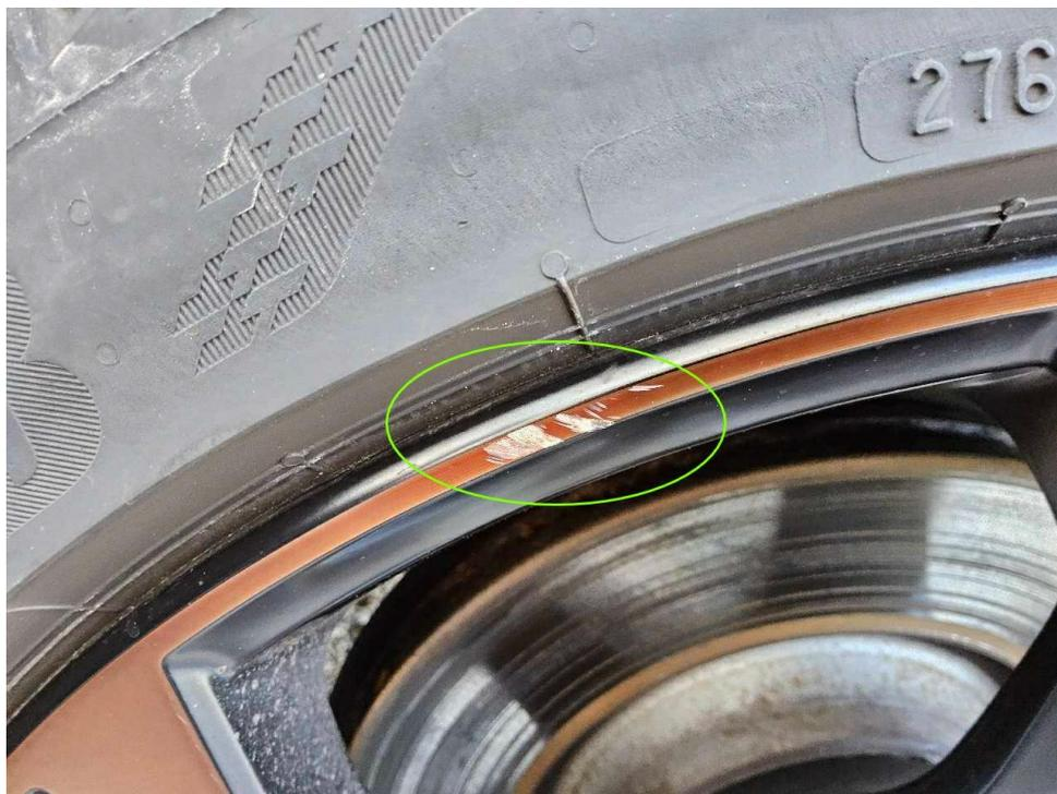
Bild 38 : Felge glanzgedreht BiColor vorne rechts mehrfach verschrammt mit Materialabtrag
