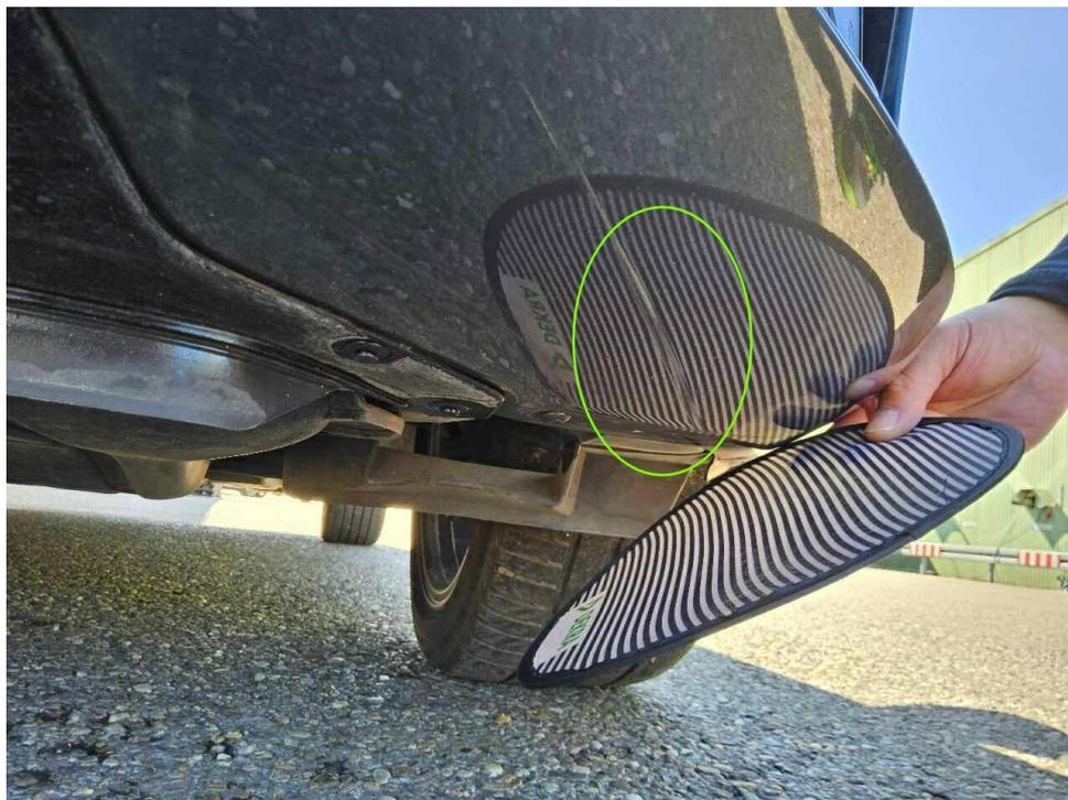
Bild 31 : Frontspoilerecke links glanzlackiert geprägt, verschrammt und Ecke deformiert
