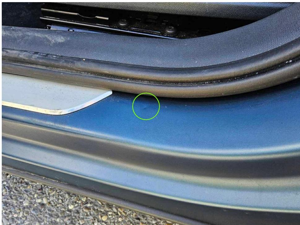
Bild 24 : Türeinstieg vorne links Lackbeschädigung und 5-fach eingedellt - Minderwert
