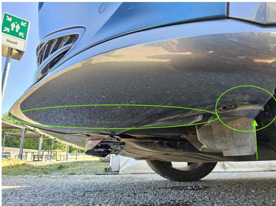
Bild 28 : Frontspoilerecke links glanzlackiert geprägt, verschrammt und Ecke deformiert
