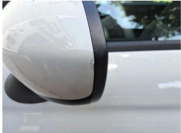
**Beschädigung #2:** Außenspiegel links: Abdeckkappe - Kratzer - Smart Repair
