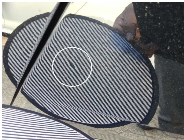
Beschädigung #1: Seitenwand links: Seitenwand - Delle(n) - sanft instandsetzen
