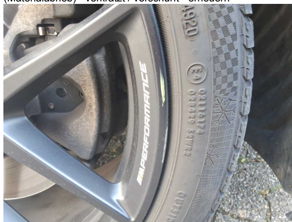
Beschädigung #6: Rad/Reifen: Leichtmetallfelge vorn rechts (Materialabrieb) - verkratzt / verschürft - erneuern
