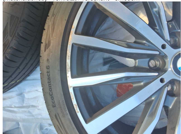
Beschädigung #8: 2.Radsatz: Leichtmetallfelgensatz komplett (Materialabrieb) - verkratzt / verschürft - erneuern
