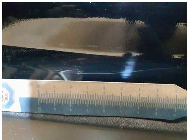
**Beschädigung #3:** Schweller links: Einstieg - Kratzer - Smart Repair
