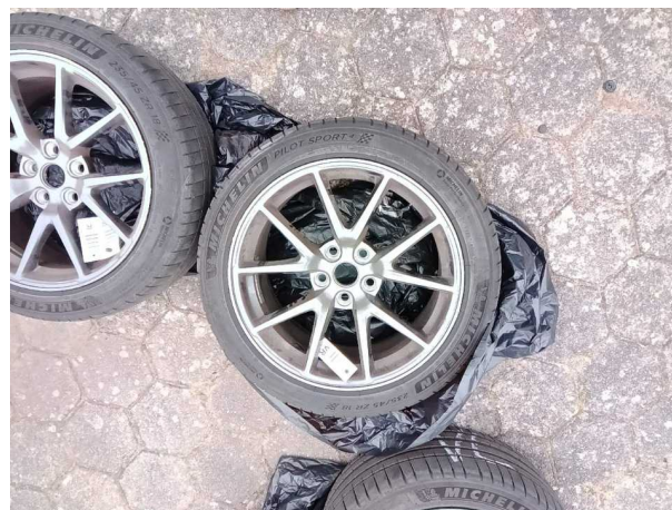
Beschädigung #4: 2.Radsatz: 2 Leichtmetallfelgen - Kratzer - erneuern
