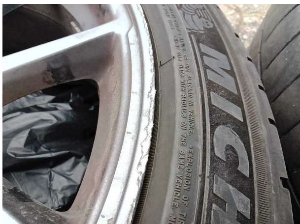
Beschädigung #4: 2.Radsatz: 2 Leichtmetallfelgen - Kratzer - erneuern
