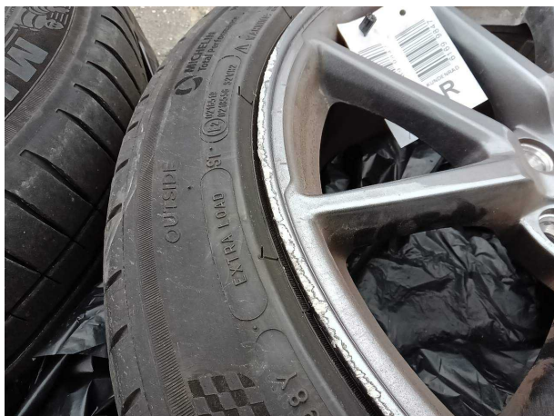
Beschädigung #4: 2.Radsatz: 2 Leichtmetallfelgen - Kratzer - erneuern
