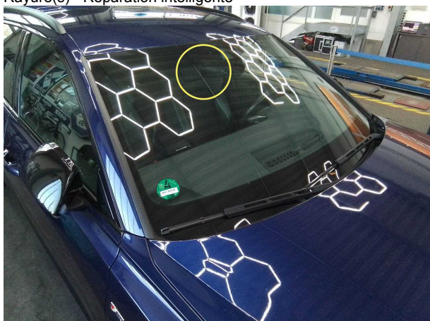
Domage #6: Vitrage: Pare-brise (Steinschlag) - Cassé/déchiré - Remplacer
