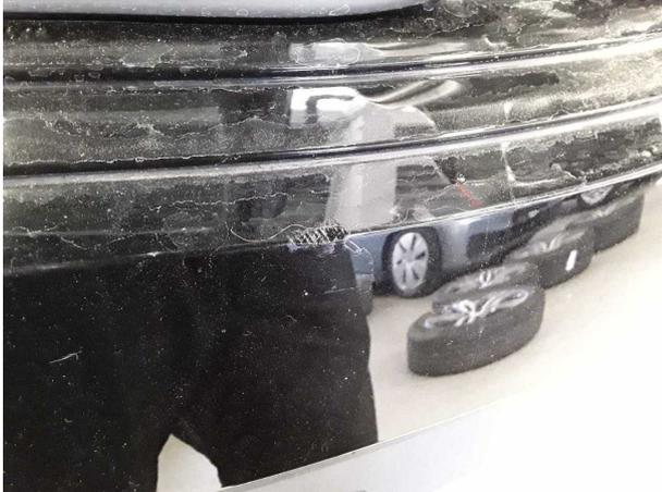
**Domage #7:** Pare-chocs arrière: Pare-chocs arrière - Eraflé - Réparer et repeindre
