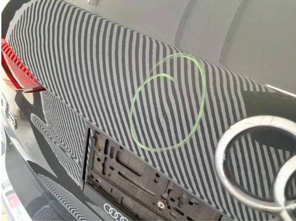
**Beschädigung #5:** Heckklappe/-tür: Heckklappe - Delle / Lackschaden - Smart Repair
