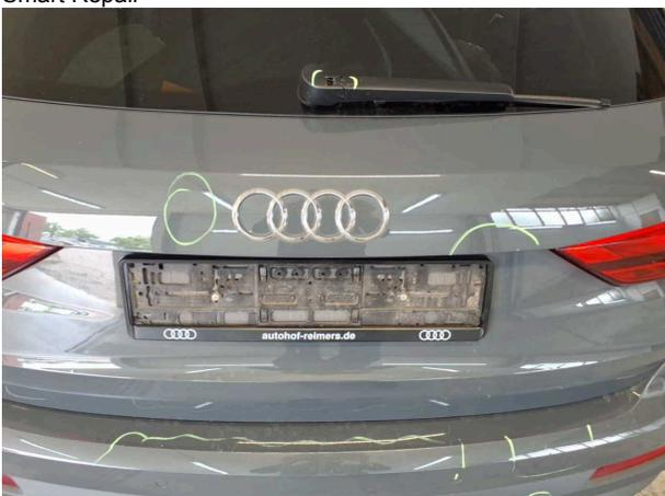
**Beschädigung #5:** Heckklappe/-tür: Heckklappe - Delle /
