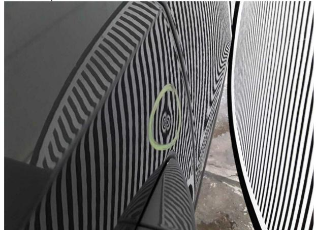
**Beschädigung #4:** Tür hinten links: Tür - Delle / Lackschade...
