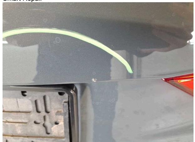
**Beschädigung #5:** Heckklappe/-tür: Heckklappe - Delle /
