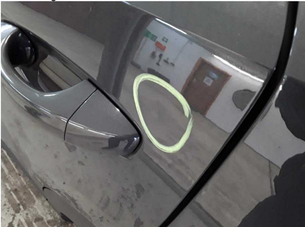
**Beschädigung #4:** Tür hinten links: Tür - Delle / Lackschaden -
