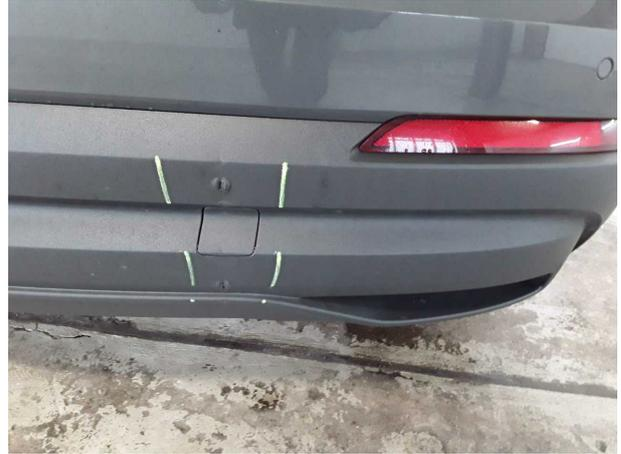
**Beschädigung #6:** Stossfänger hinten: Spoiler - beschädigt - erneuern
