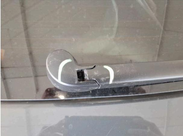
**Beschädigung #2:** Scheibenreinigung: Scheibenwischerarm hinten...
