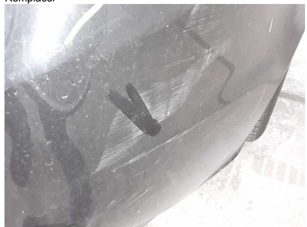
Domage #6: Pare-chocs arrière: Pare-chocs arrière - Erafilé - Réparer et repeindre
