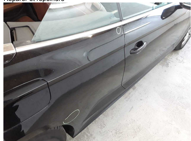
Domage #8: Panneau latéral arrière droit: Paroi latérale - bosse(s) - Réparer et repeindre
