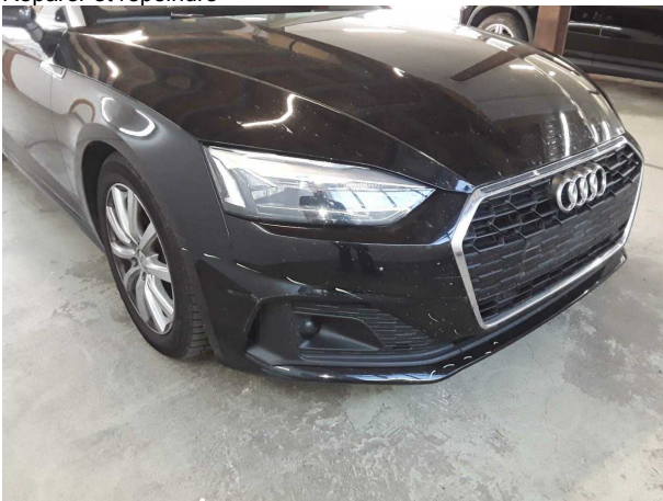
Domage #7: Pare-chocs avant: Pare-chocs avant - Erafilé - Réparer et repeindre
