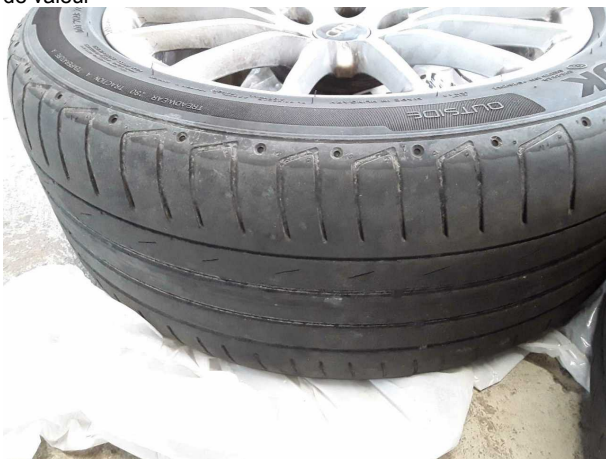
Domage #4: 2e Jeu de roues: 2 Pneus - Usé - Remplacer
