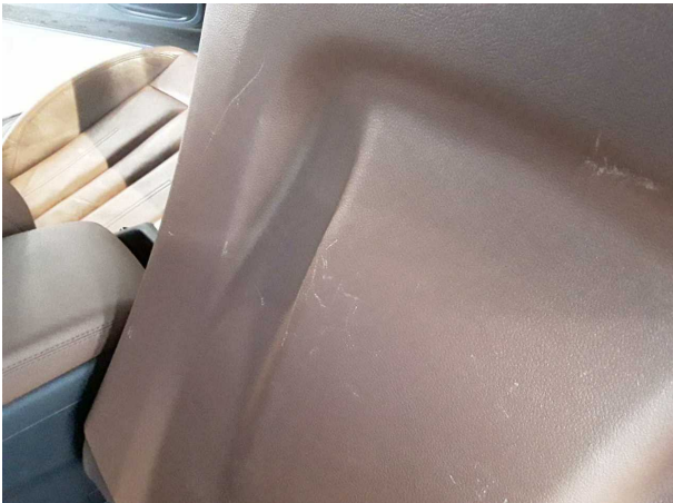
Domage #1: Siège avant: Habillage coffret siège droite - Erafilé - Diminution de valeur
