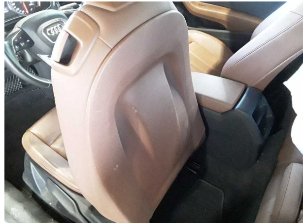
Domage #2: Siège avant: Habillage coffret siège gauche - Erafilé - Diminution de valeur
