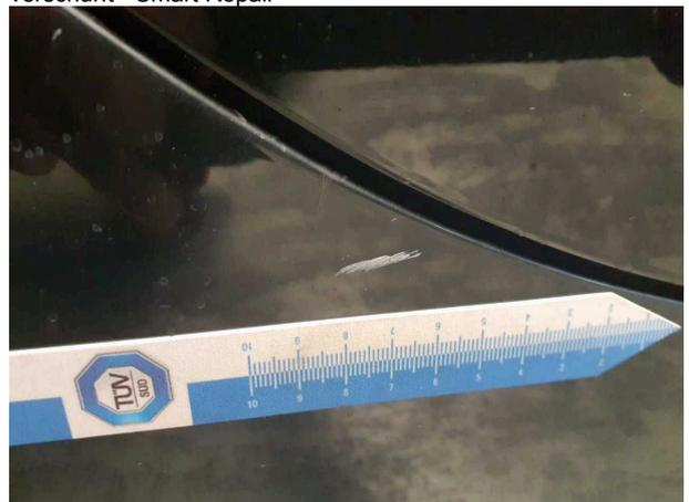
**Beschädigung #8:** Schweller rechts: Verkleidung - verkratzt / verschürft - Smart Repair
