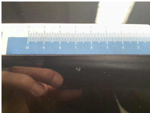
**Beschädigung #9:** Tür hinten rechts: Tür - Delle / Lackschaden -
