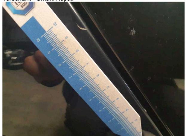
**Beschädigung #7:** Seitenwand rechts: Kniestück - verkratzt / verschürft - Smart Repair
