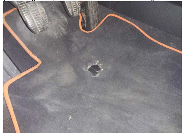
**Beschädigung #2:** Verkleidungen/Abdeckungen: Fußmatten - Löcher - erneuern
