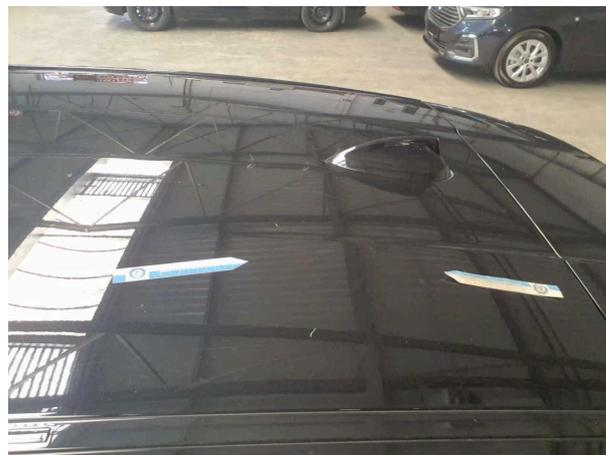
**Beschädigung #15:** Fahrzeugdach: Dach - verkratzt / verschürft - lackieren
