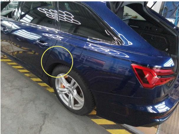
**Beschädigung #5:** Seitenwand links: Seitenwand - Kratzer - Smart Repair
