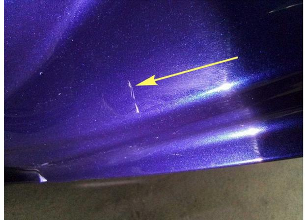
**Beschädigung #4:** Seitenwand links: Einstieg - Kratzer - Sm...
