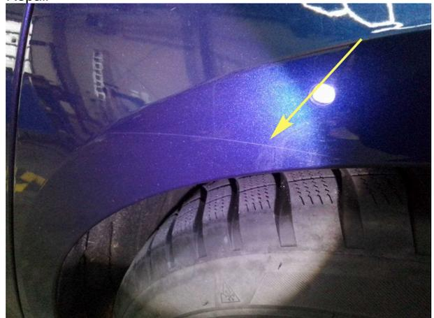
**Beschädigung #5:** Seitenwand links: Seitenwand - Kratzer -
