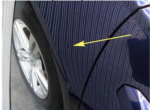
**Beschädigung #2:** Seitenwand rechts: Seitenwand - Delle(n) -
