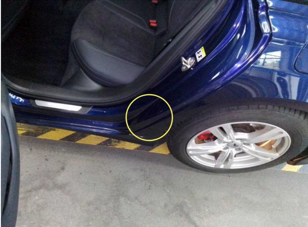
**Beschädigung #4:** Seitenwand links: Einstieg - Kratzer - Smart Repair
