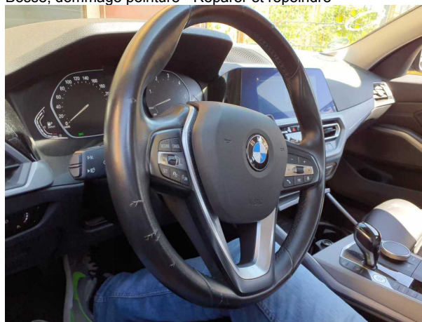
Domage #14: Dispositif de direction: Garniture volant - Cassé/déchiré - Remplacer
