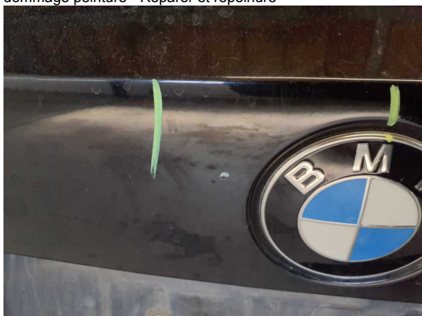
Domage #15: Hayon/Porte arrière: Couvercle de coffre - Bosse, dommage peinture - Réparer et repeindre
