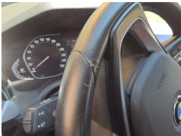
Domage #14: Dispositif de direction: Garniture volant - Cassé/déchiré - Remplacer
