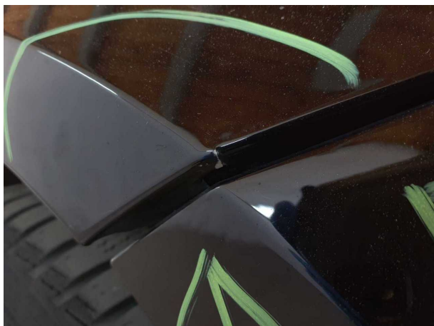
Domage #11: Garde-boue droit: Garde-boue droit - Cassé/déchiré - Remplacer
