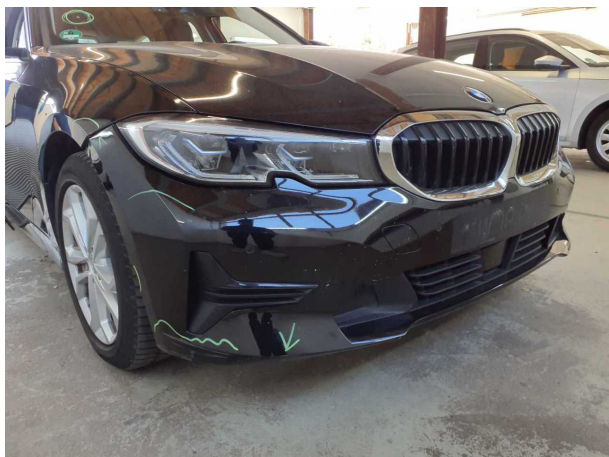
Dommage #19: Pare-chocs avant: Pare-chocs avant - Dommage... Remplacer
