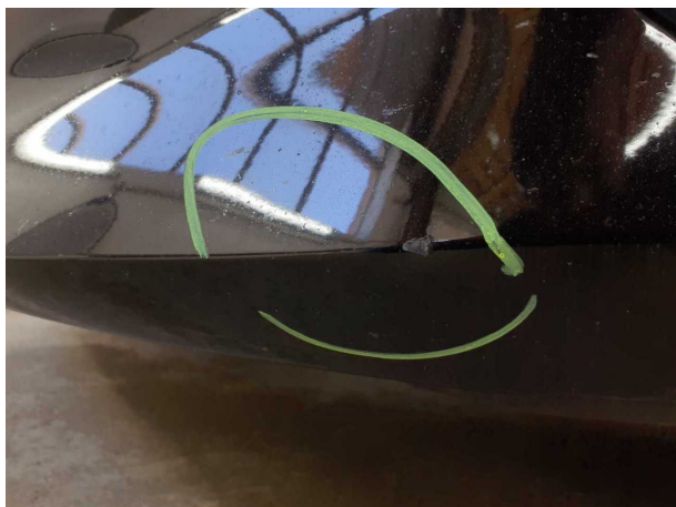
Domage #19: Pare-chocs avant: Pare-chocs avant - Dommage... Remplacer
