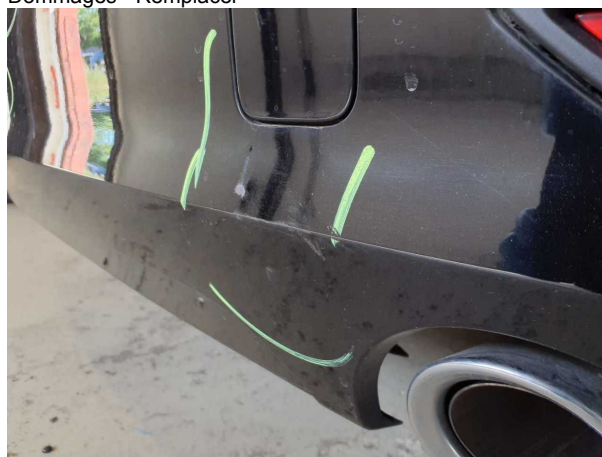
Dommage #18: Pare-chocs arrière: Pare-chocs arrière - Dommages - Remplacer
