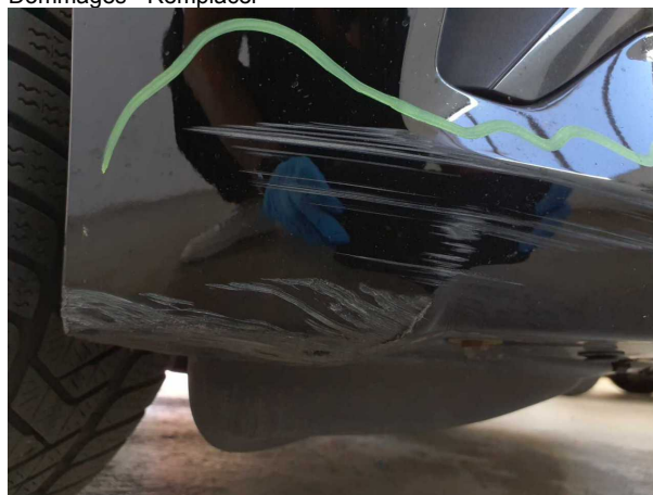
Dommage #19: Pare-chocs avant: Pare-chocs avant - Dommages - Remplacer
