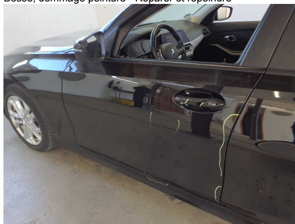
Domage #16: Porte AvG: Porte - Eraflé - Réparer et repeindre
