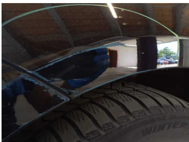
Domage #8: Garde-boue gauche: Garde-boue gauche - Bosse, dommage peinture - Réparer et repeindre
