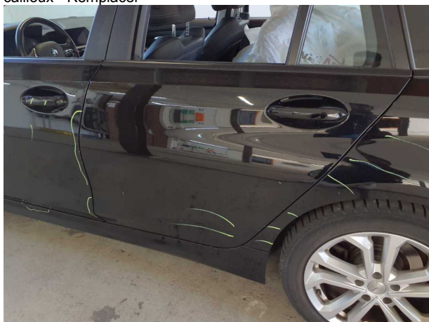
Dommage #10: Porte ArG: Porte - Eraflé - Peinture
