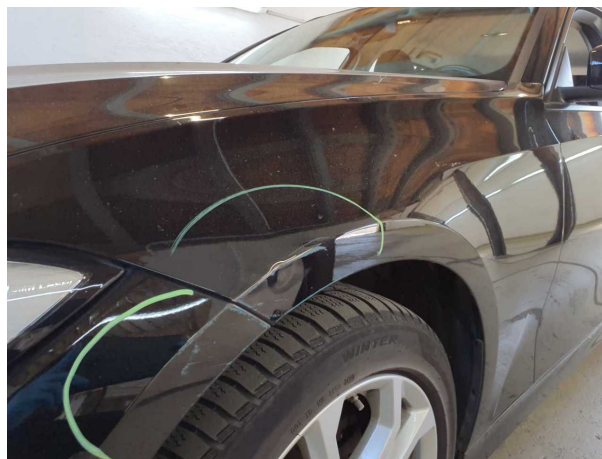
Domage #8: Garde-boue gauche: Garde-boue gauche - Bosse, dommage peinture - Réparer et repeindre
