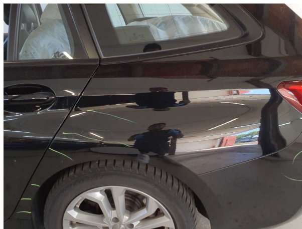
Domage #12: Panneau latéral arrière gauche: Paroi latérale... Erafilé - Peinture
