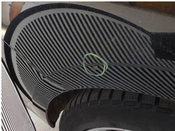
Domage #13: Panneau latéral arrière droit: Paroi latérale - Bosse, dommage peinture - Réparer et repeindre
