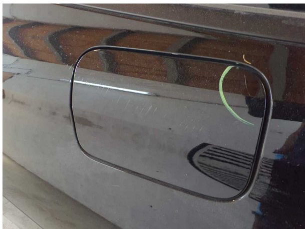
Dommage #1: Circuit de carburant: Couvercle réservoir - Erafilé - Réparation intelligente
