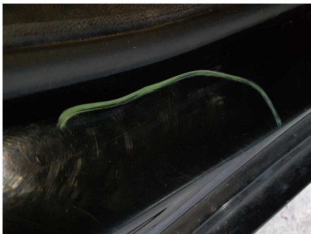
Domage #6: Panneau latéral arrière droit: Accès - Eraflé - Réparation intelligente
