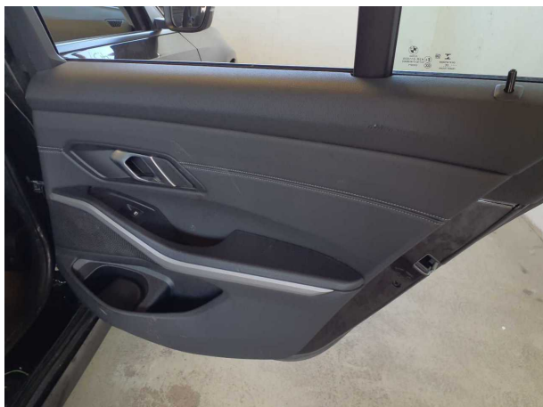
Domage #4: Habillages/Protections: Habillage porte arrière dro... - Erafle - Diminution de valeur
