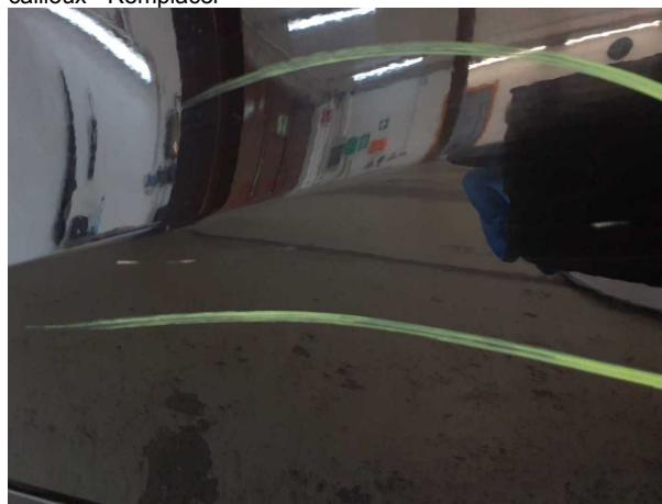
Dommage #10: Porte ArG: Porte - Eraflé - Peinture
