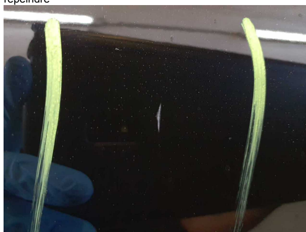
Domage #17: Porte AvD: Porte - Erafilé - Réparer et repeindre
