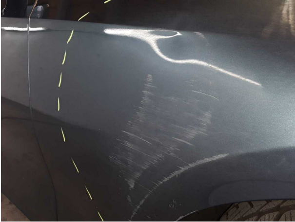
Dommage #5: Garde-boue droit: Garde-boue droit - Bosse, dommage peinture - Réparer et repeindre
