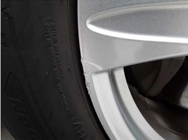
**Beschädigung #1:** Rad/Reifen: Leichtmetallfelge vorn rechts (Materialabtrag optisch gering) - verkratzt / verschürft - kein Abzug
