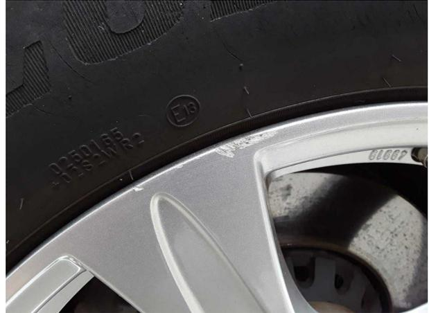
**Beschädigung #1:** Rad/Reifen: Leichtmetallfelge vorn rechts (Materialabtrag optisch gering) - verkratzt / verschürft - kein
