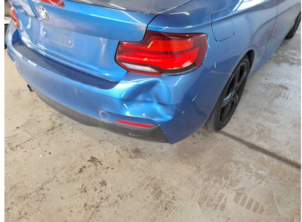
Dommage #10: Pare-chocs arrière: Pare-chocs arrière - Dommages - Remplacer
