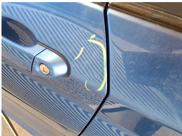
Domage #5: Porte AvG: Porte - bosse(s) - Bon travail de réparation
