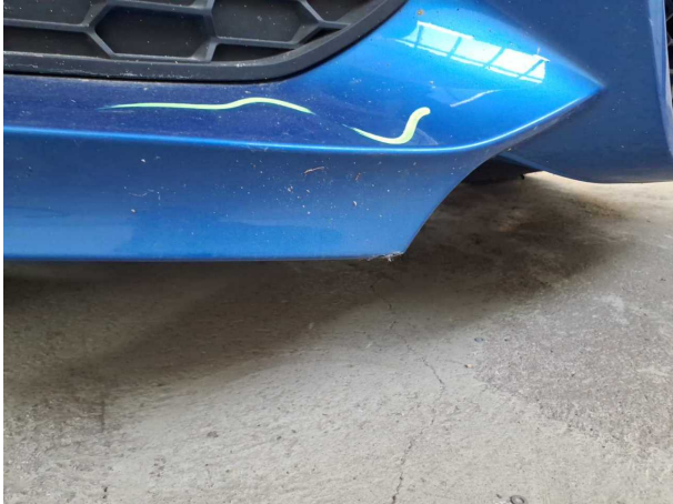
Dommage #9: Pare-chocs avant: Pare-chocs avant - Erafilé - Réparer et repeindre
