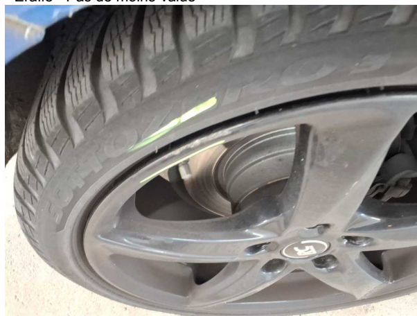
Dommage #2: Roue / Pneumatiques: Jante alliage arrière droite - Eraflé - Pas de moins-value
