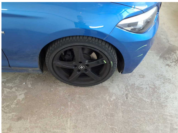
Dommage #1: Roue / Pneumatiques: Jante alliage avant droite - Eraflé - Pas de moins-value
