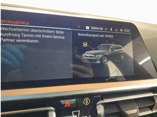
**Domage #2:** Système de freinage: Liquide de frein - Exigible - Remplacer
