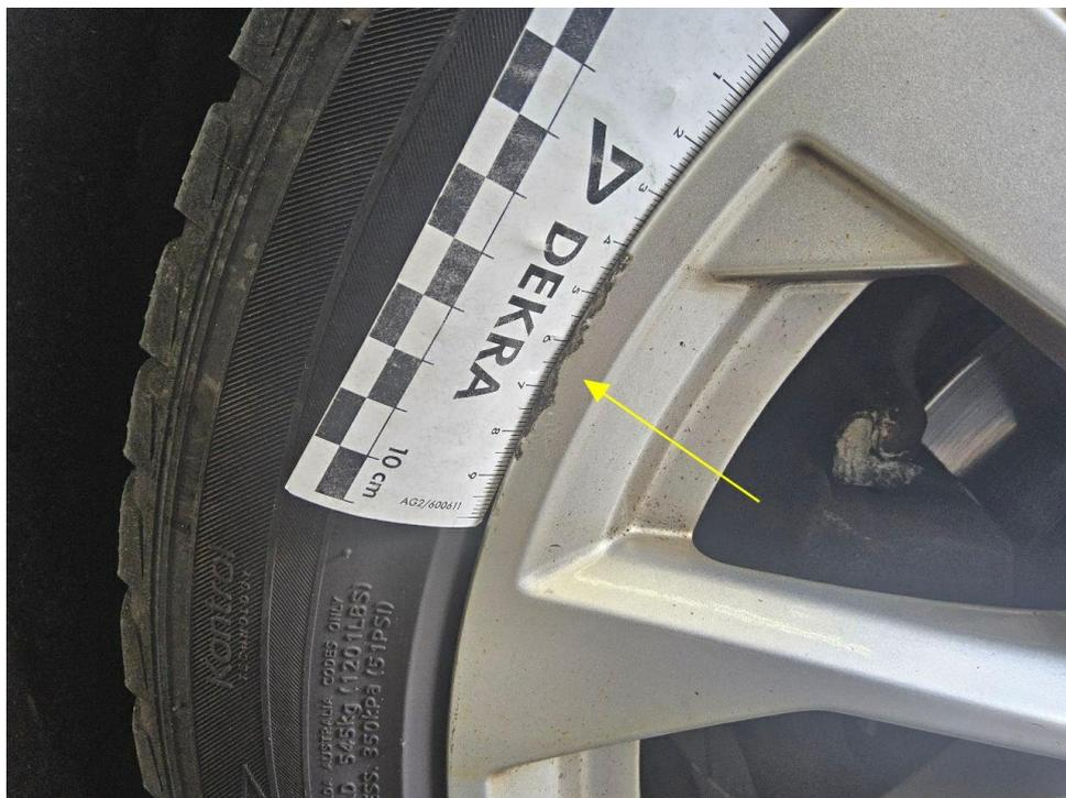
Bild 26 : Felge vorne links, zerkratzt
