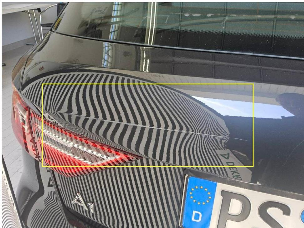
Bild 20 : Heckklappe, deformiert
