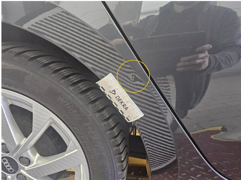
Bild 15 : Seitenteil hinten rechts, eingedellt, drücken
