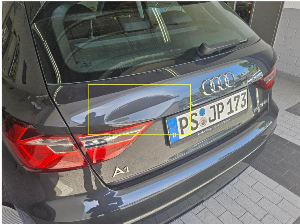
Bild 19 : Heckklappe, deformiert
