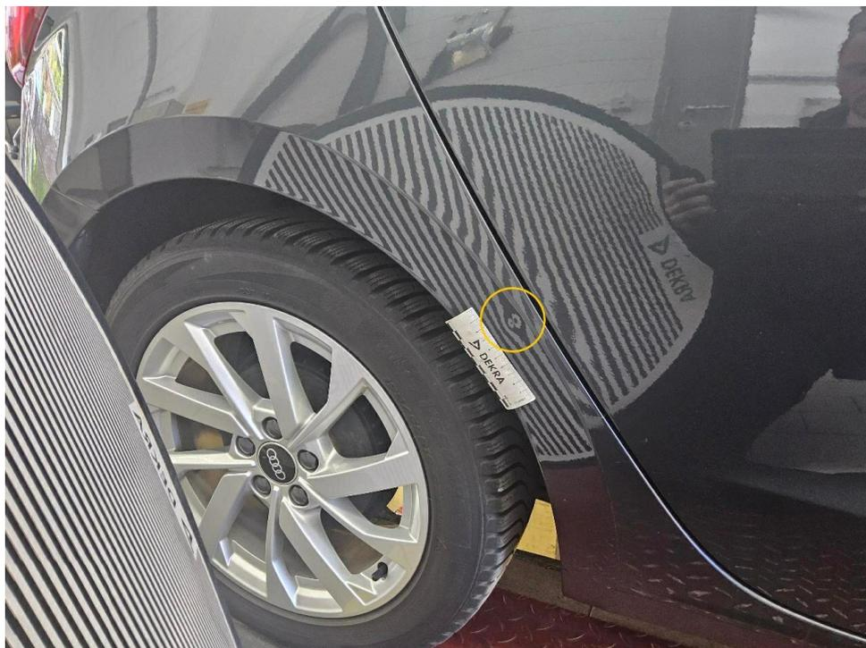
Bild 14 : Seitenteil hinten rechts, eingedellt, drücken
