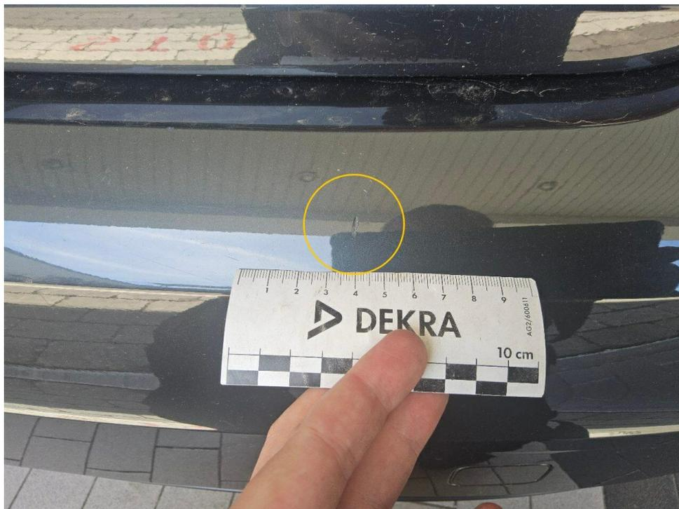
Bild 17 : Stoßfänger hinten Lackierung, zerkratzt, lackieren mit Lackaufbau
