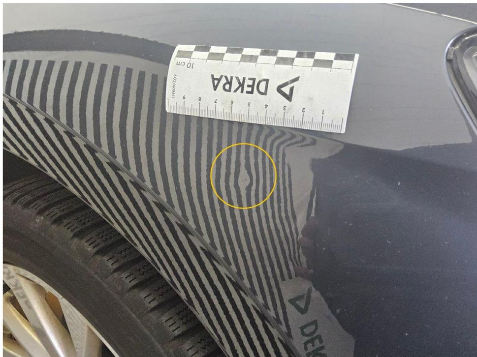
Bild 13 : Kotflügel vorne rechts, eingedellt, Gebrauchsspur
