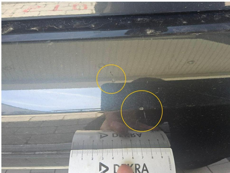
Bild 18 : Stoßfänger hinten Lackierung, zerkratzt, lackieren mit Lackaufbau
