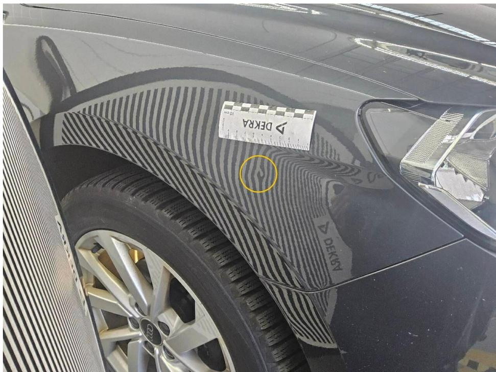
Bild 12 : Kotflügel vorne rechts, eingedellt, Gebrauchsspur
