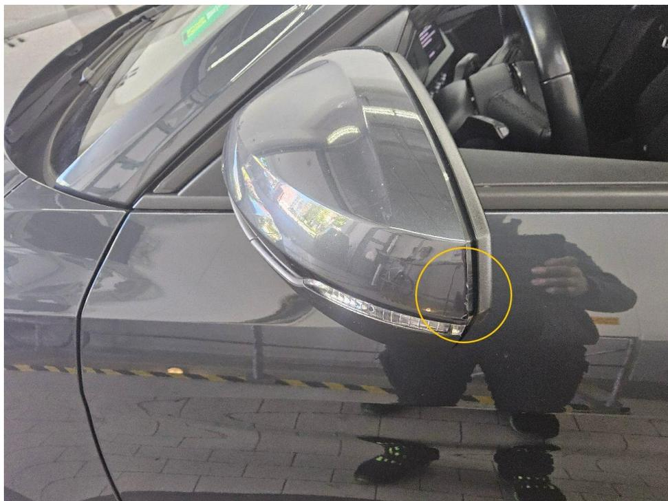
Bild 24 : Außenspiegelverkleidung links, zerkratzt
