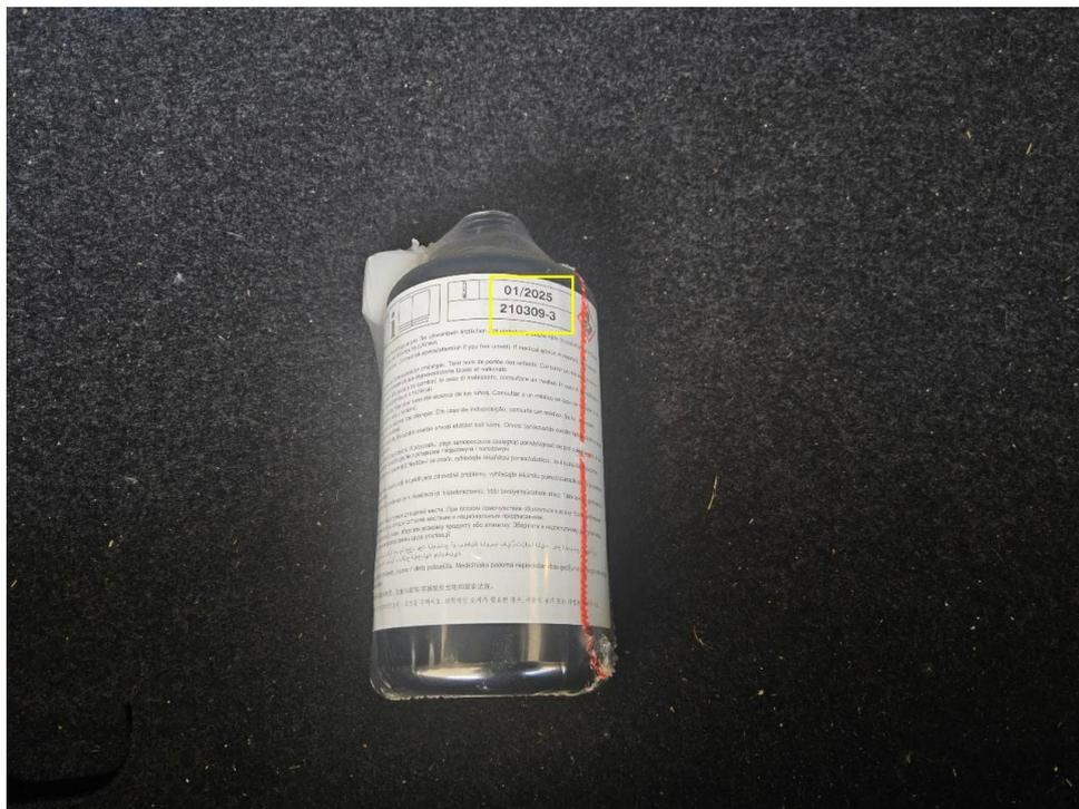
Bild 27 : Pannenset Reifendichtmittel, abgelaufen
