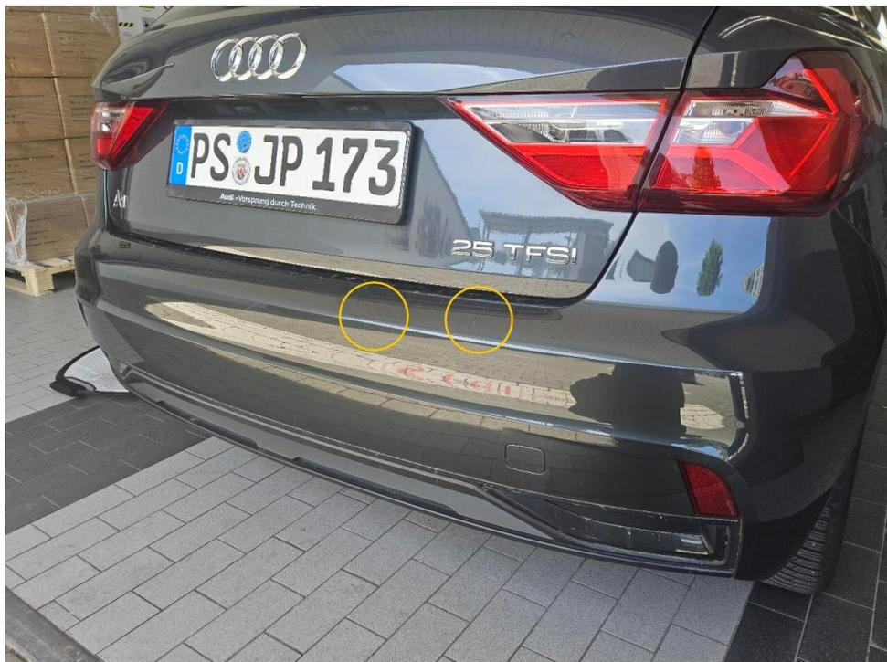
Bild 16 : Stoßfänger hinten Lackierung, zerkratzt, lackieren mit Lackaufbau
