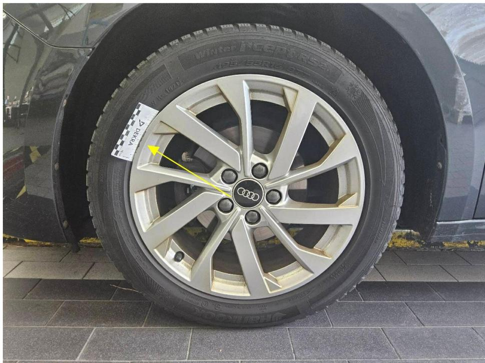
Bild 25 : Felge vorne links, zerkratzt
