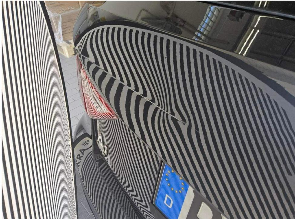
Bild 21 : Heckklappe, deformiert
