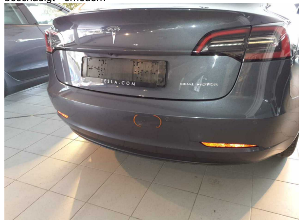
Beschädigung #9: Stossfänger hinten: Stossfänger hinten - verkratzt / verschürft - lackieren
