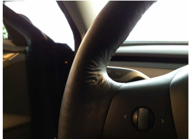
Beschädigung #8: Lenkanlage: Lenkrad (Leder löst sich) - beschädigt - erneuern
