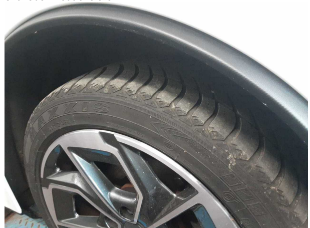
Beschädigung #6: Rad/Reifen: Reifen hinten - verschlissen - erneuern
