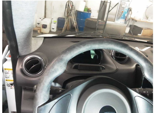
Beschädigung #4: Lenkanlage: Lenkrad - verschmutzt - reinigen
