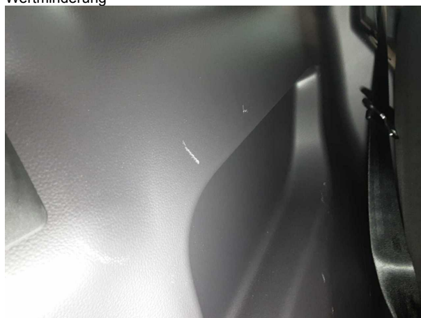
Beschädigung #3: Seitenwand rechts: Innenverkleidung - Kratze... Wertminderung
