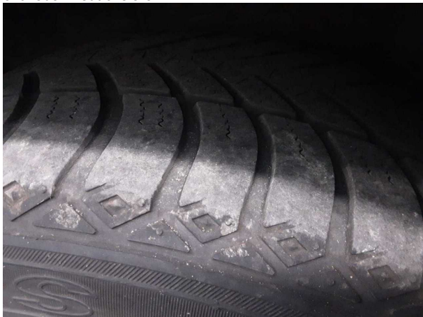
Beschädigung #6: Rad/Reifen: Reifen hinten - verschlissen - erneuern
