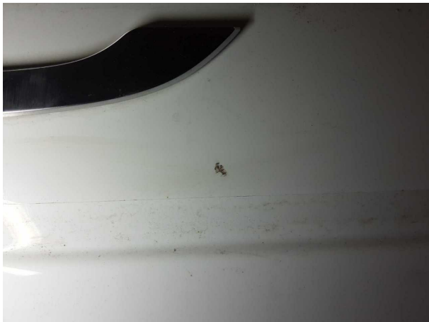
Beschädigung #7: Motorhaube: Motorhaube - Steinschlag - Smart Repair
