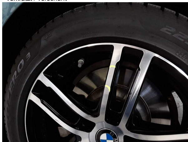
Beschädigung #2: Rad/Reifen: Leichtmetallfelge hinten links - verkratzt / verschürft
