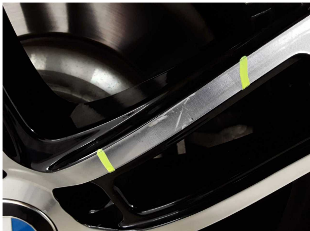
Beschädigung #1: Rad/Reifen: Leichtmetallfelge hinten rechts - verkratzt / verschürft
