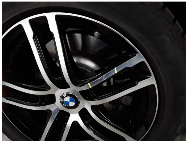
Beschädigung #1: Rad/Reifen: Leichtmetallfelge hinten rechts - verkratzt / verschürft
