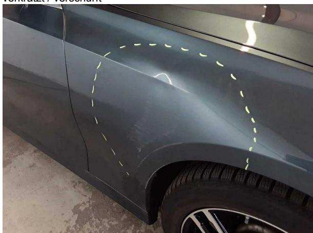
Beschädigung #5: Kotflügel rechts: Kotflügel rechts - Delle / Lackschaden - instandsetzen und lackieren
