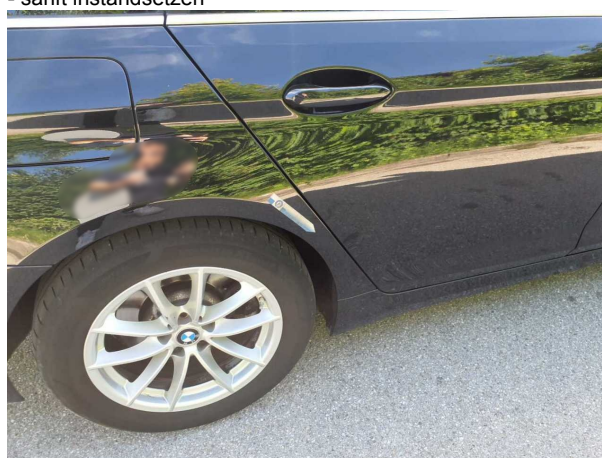
Beschädigung #4: Seitenwand rechts: Seitenwand - verformt - sanft instandsetzen
