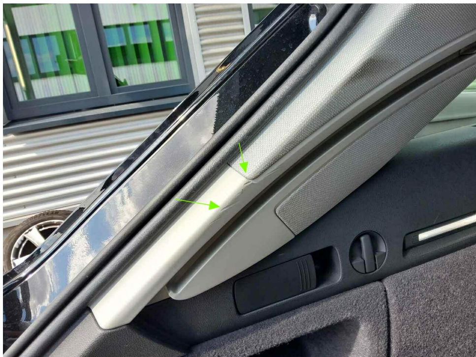
Bild 16 : D Säulenverkleidung links und rechts verschrammt
