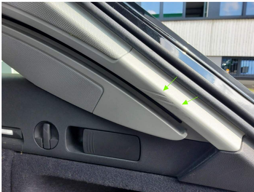
Bild 17 : D Säulenverkleidung links und rechts verschrammt
