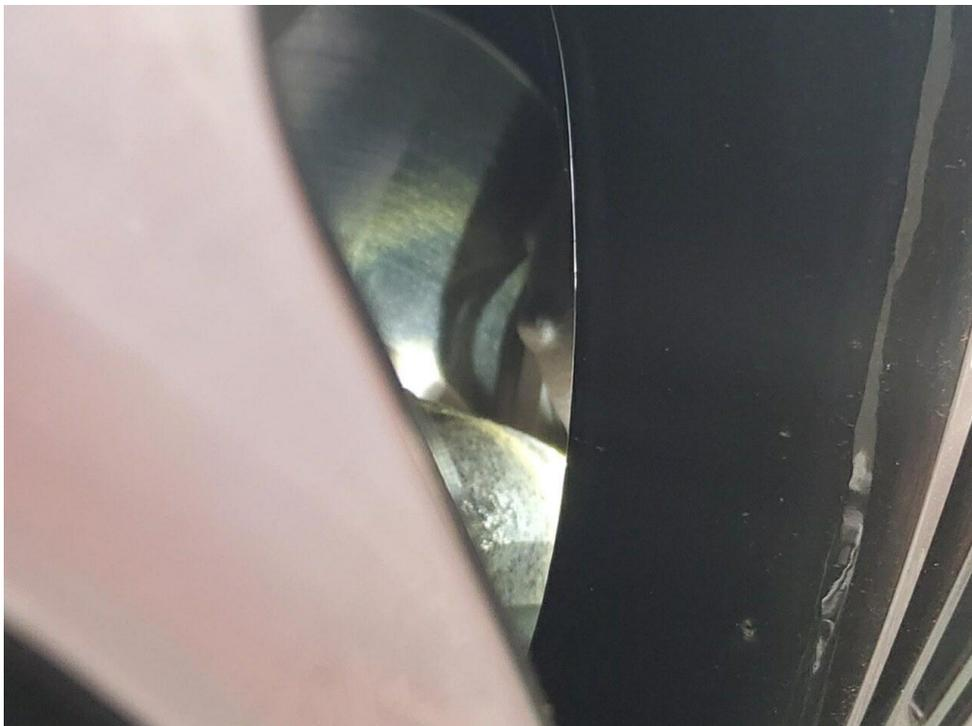
Bild 16 : Bremse hinten Beläge Scheibenbremse, verschlissen, erneuern
