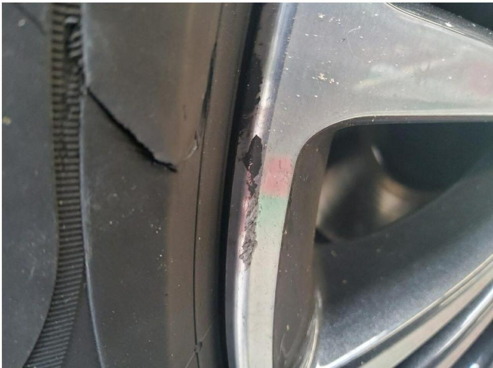
Bild 22 : Felge vorne links, zerkratzt, erneuern
