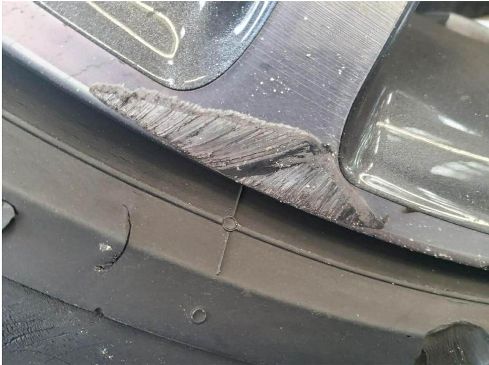
Bild 23 : Felge vorne links, zerkratzt, erneuern
