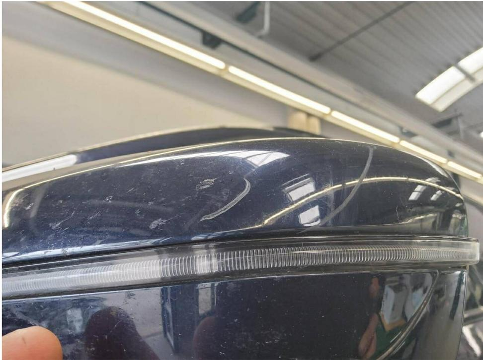
Bild 21 : Außenspiegel links Lackierung, zerkratzt, lackieren
