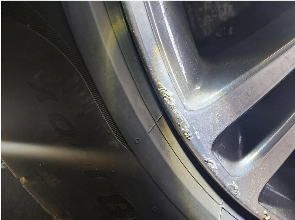
Bild 15 : Felge vorne rechts, zerkratzt, erneuern
