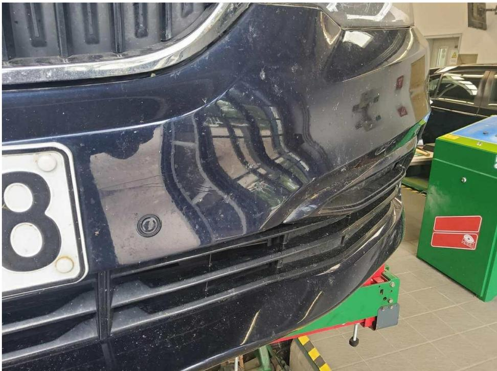
Bild 26 : Stoßfänger vorne, deformiert, erneuern und lackieren mit Lackaufbau
