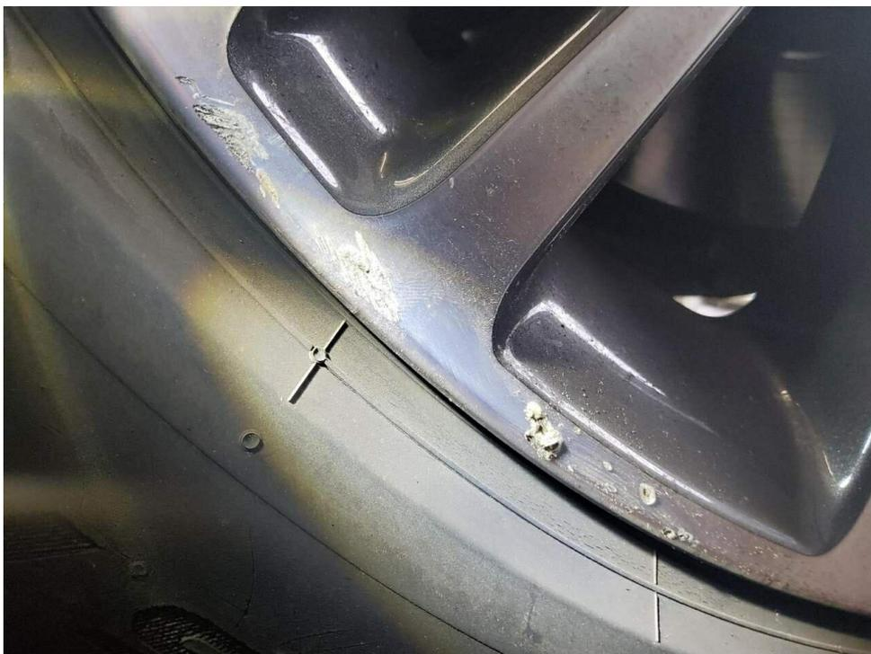
Bild 14 : Felge vorne rechts, zerkratzt, erneuern
