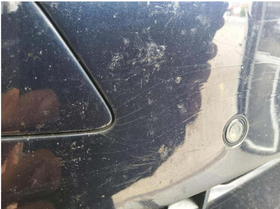
Bild 24 : Stoßfänger vorne, deformiert, erneuern und lackieren mit Lackaufbau
