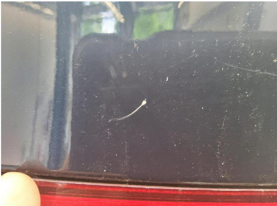
Bild 18 : Heckklappe Lackierung, zerkratzt, smart repair
