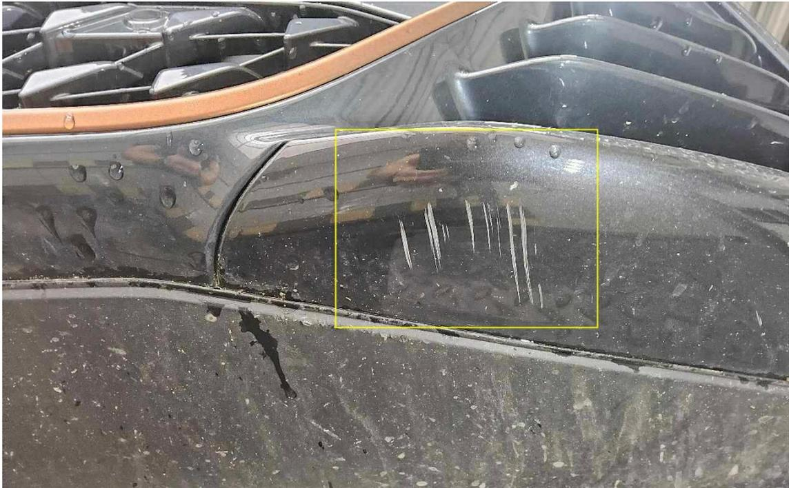
Bild 15 : Stoßfängerverkleidung vorne unterhalb verschrammt
