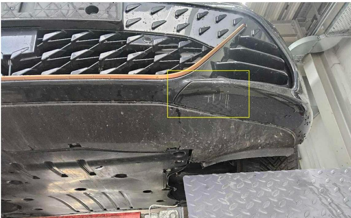
Bild 14 : Stoßfängerverkleidung vorne unterhalb verschrammt
