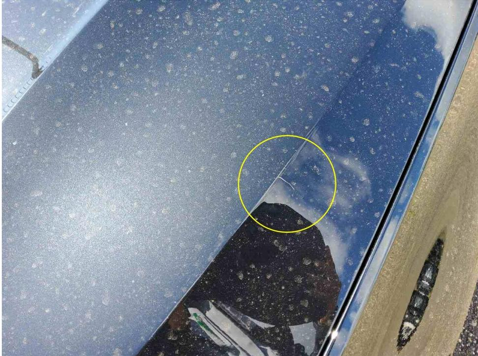
Bild 17 : Motorhaube verkratzt
