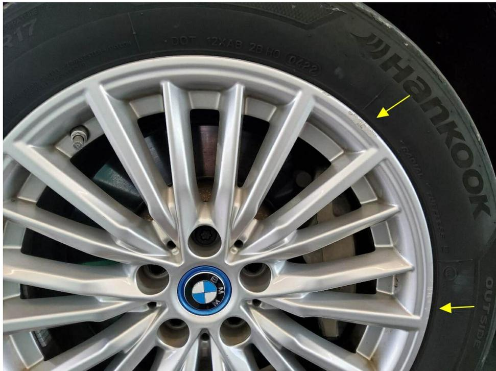
Bild 15 : Leichtmetallfelge vorn links verschrammt
