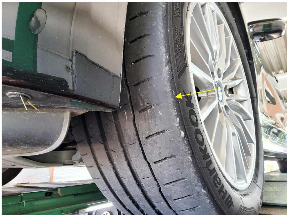
Bild 20 : Vorderreifen aussen abgefahren
