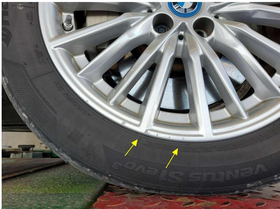
Bild 16 : Leichtmetallfelge vorn rechts verschrammt
