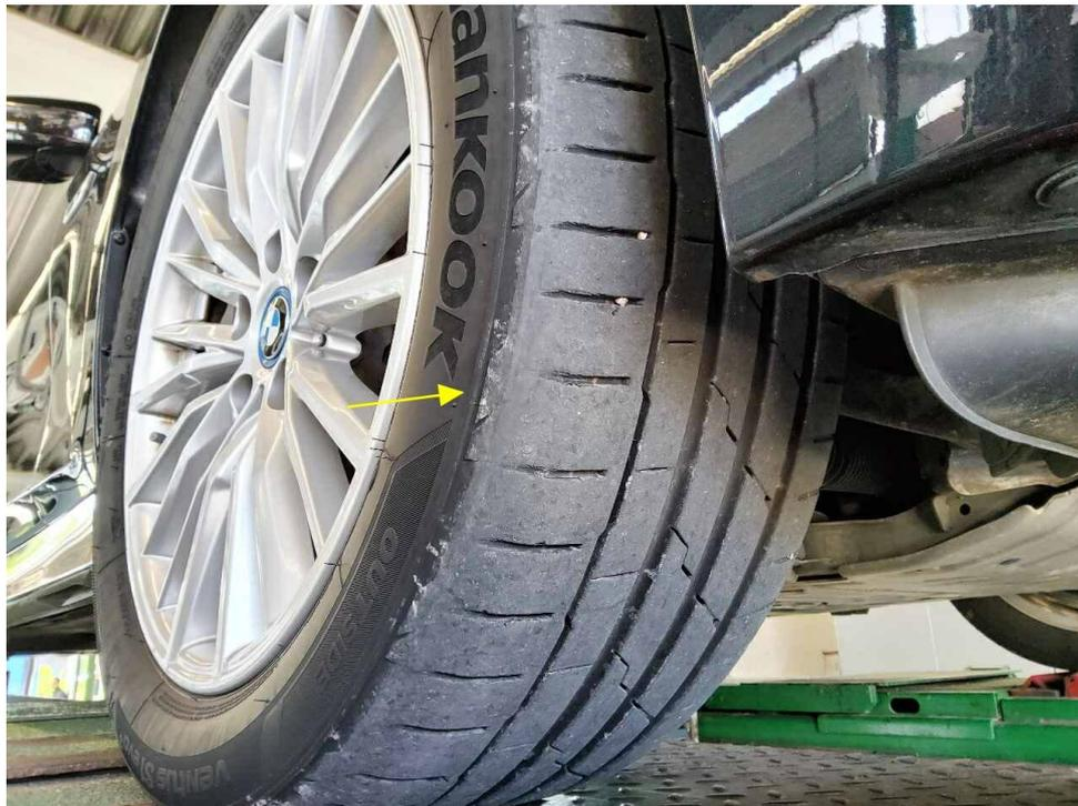
Bild 19 : Vorderreifen aussen abgefahren
