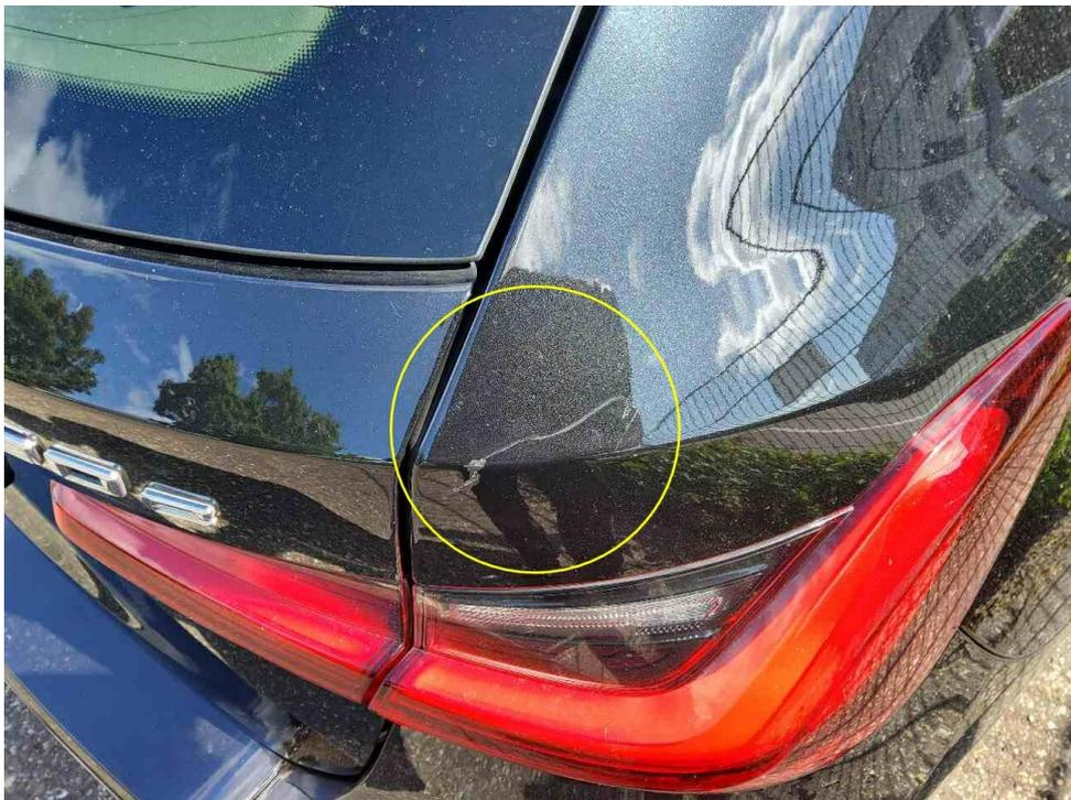
Bild 18 : Seitenwand rechts verkratzt
