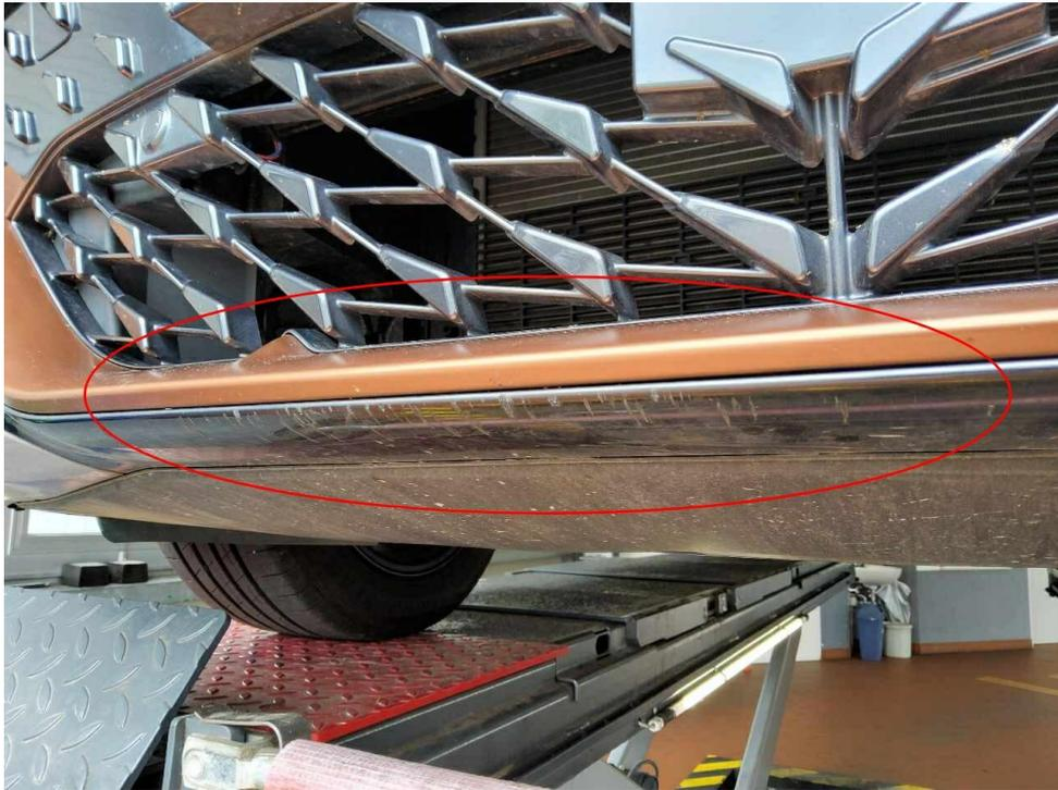
Bild 17 : Stoßfänger vorne Spoiler unten, Kratzer mit Lackabrieb
