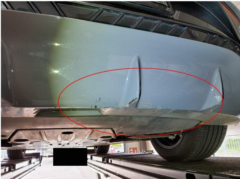
Bild 16 : Stoßfänger hinten Spoiler unten, verschrammt mit Lackabrieb
