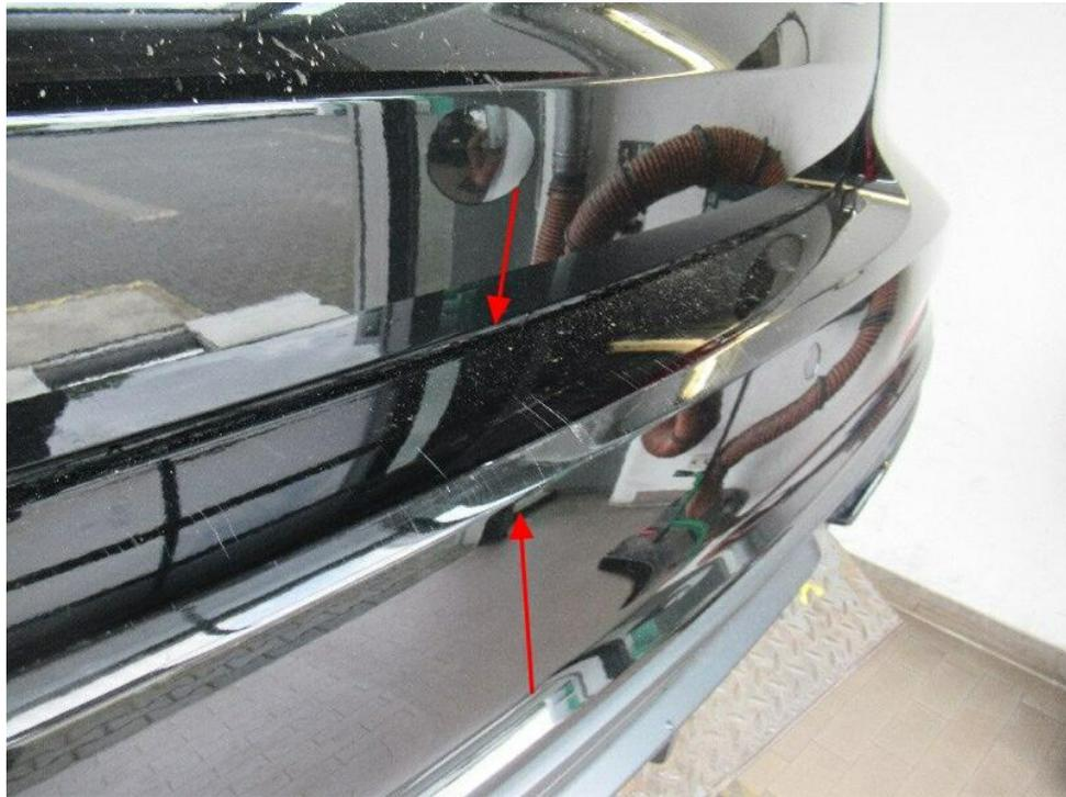
Bild 19 : Stoßfänger hinten Lackierung, zerkratzt, smart repair
