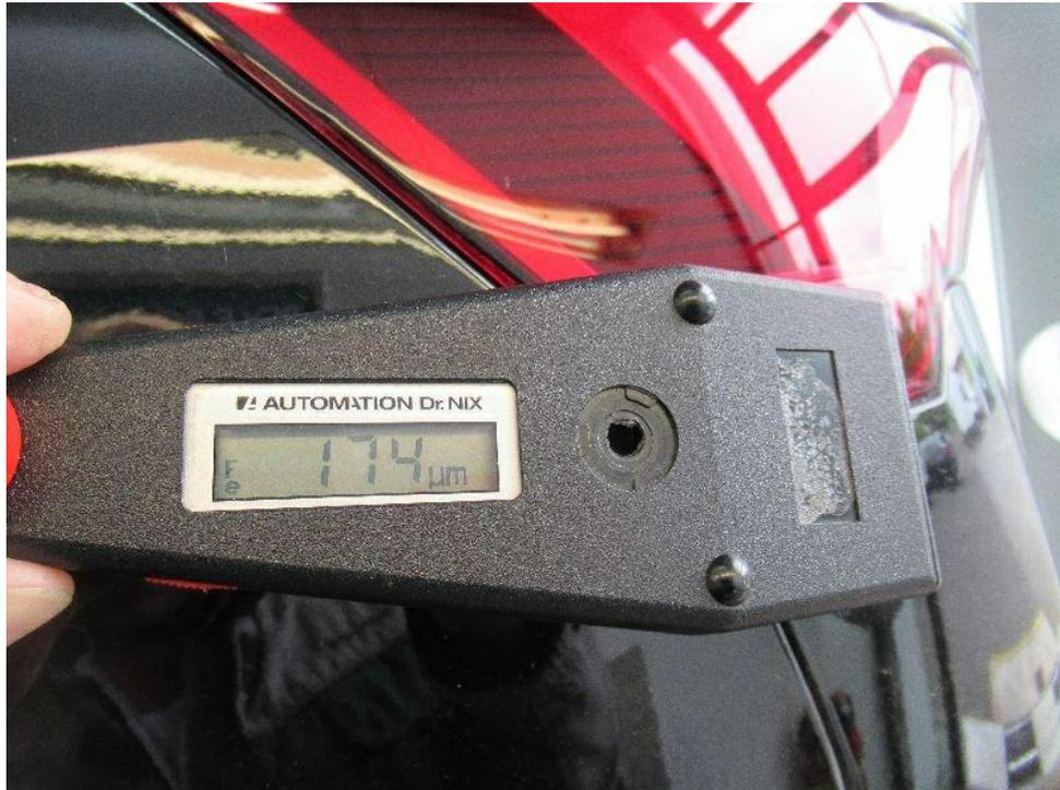
Bild 23 : Seitenteil hinten links Nachlackiert.
