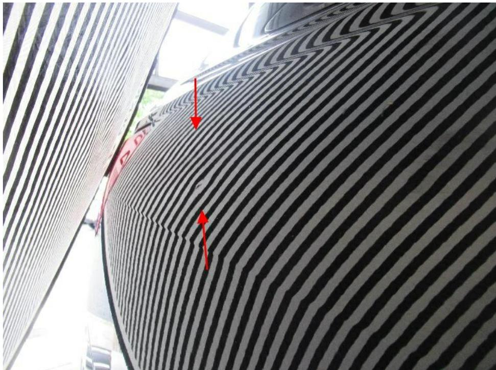
Bild 24 : Seitenteil hinten rechts, eingedellt, drücken
