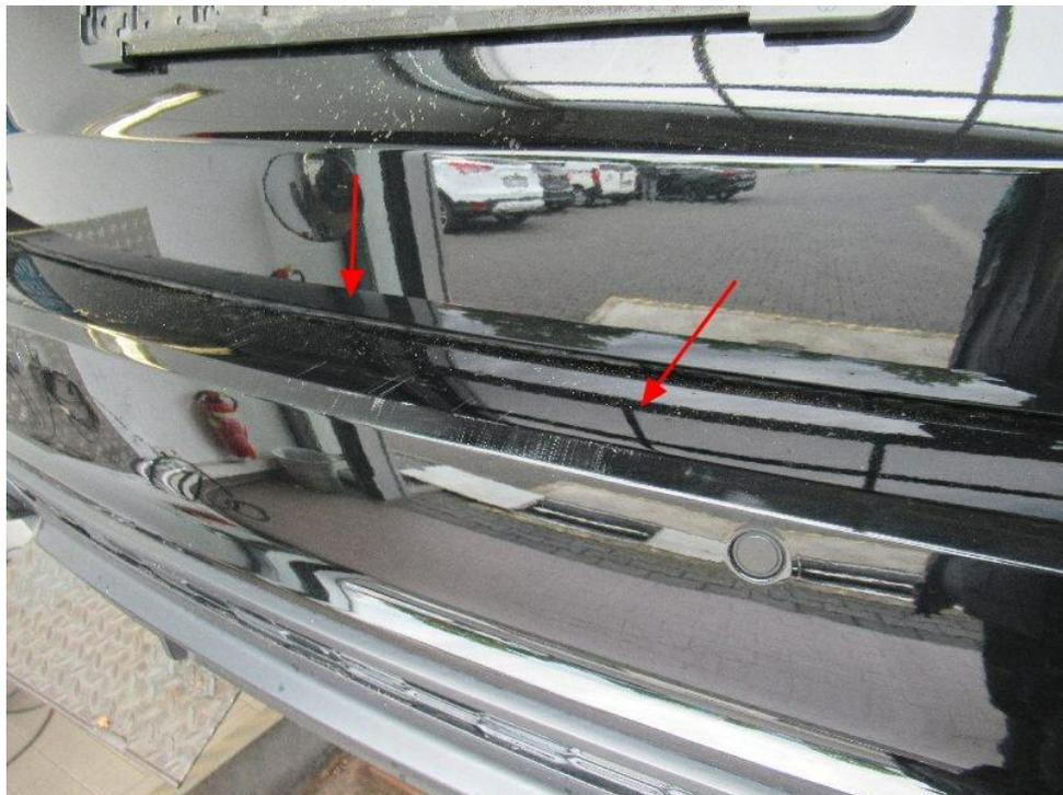
Bild 20 : Stoßfänger hinten Lackierung, zerkratzt, smart repair
