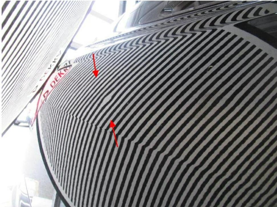
Bild 25 : Seitenteil hinten rechts, eingedellt, drücken
