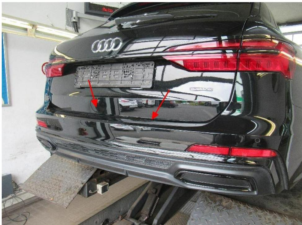
Bild 18 : Stoßfänger hinten Lackierung, zerkratzt, smart repair
