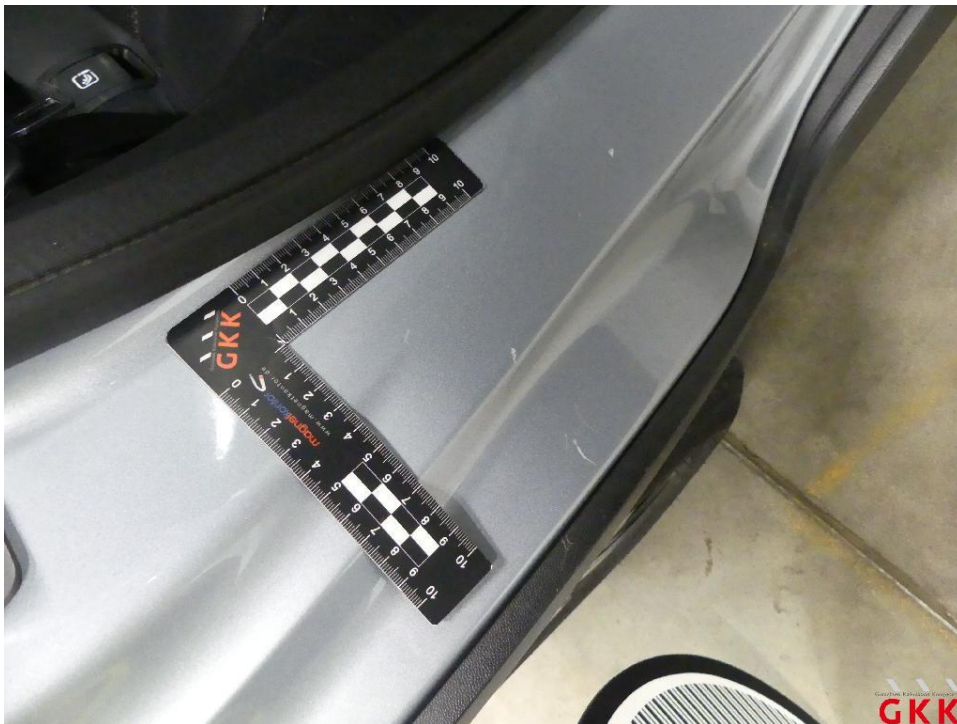
Bild 18 Tür hinten rechts, Einstieg, verkratzt, Smartrepair
