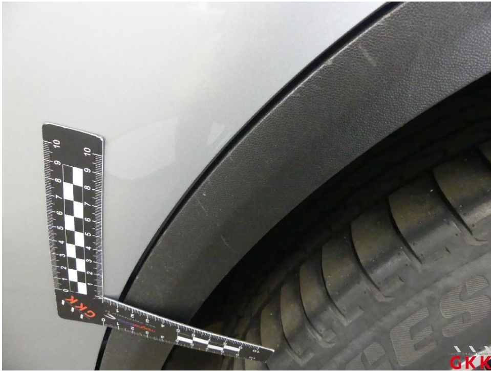
Bild 21 Seitenwand links, Leiste, Radlauf, verkratzt, ersetzen
