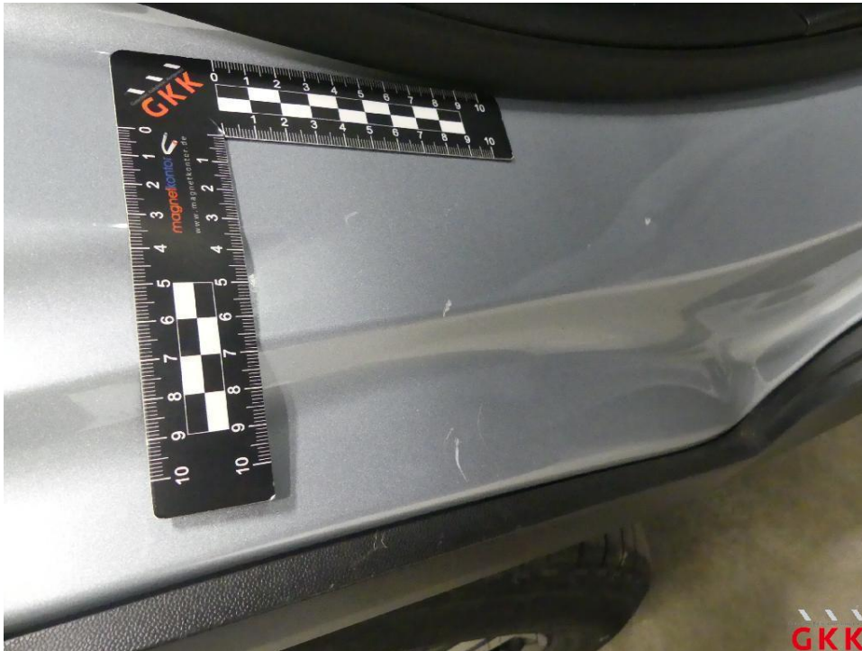
Bild 19 Tür hinten rechts, Einstieg, verkratzt, Smartrepair
