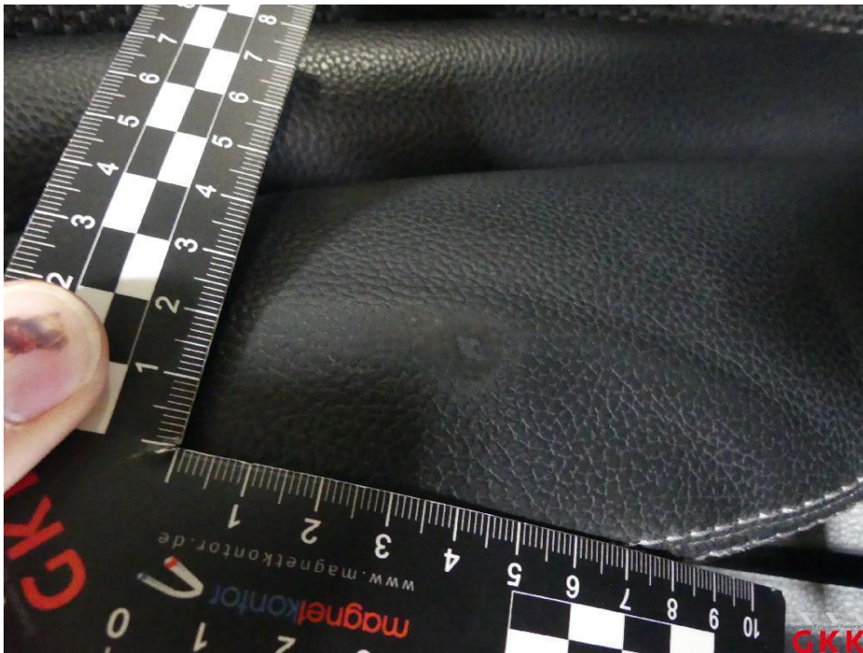
Bild 24 Sitz vorne links, Bezug Sitzkissen -Leder-, beschädigt, ersetzen
