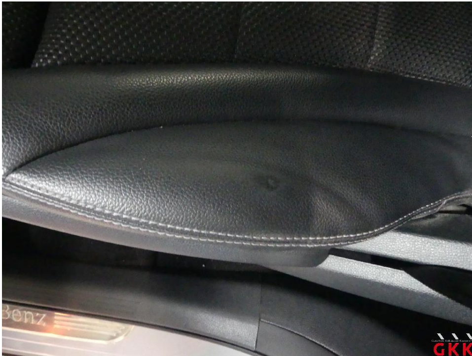
Bild 23 Sitz vorne links, Bezug Sitzkissen -Leder-, beschädigt, ersetzen
