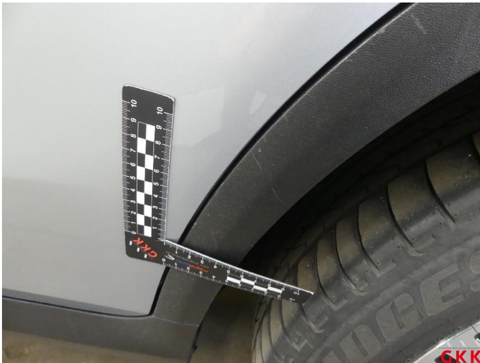
Bild 20 Seitenwand links, Leiste, Radlauf, verkratzt, ersetzen
