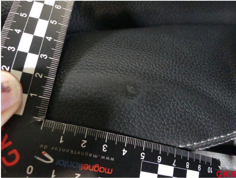
Bild 25 Sitz vorne links, Bezug Sitzkissen -Leder-, beschädigt, ersetzen
