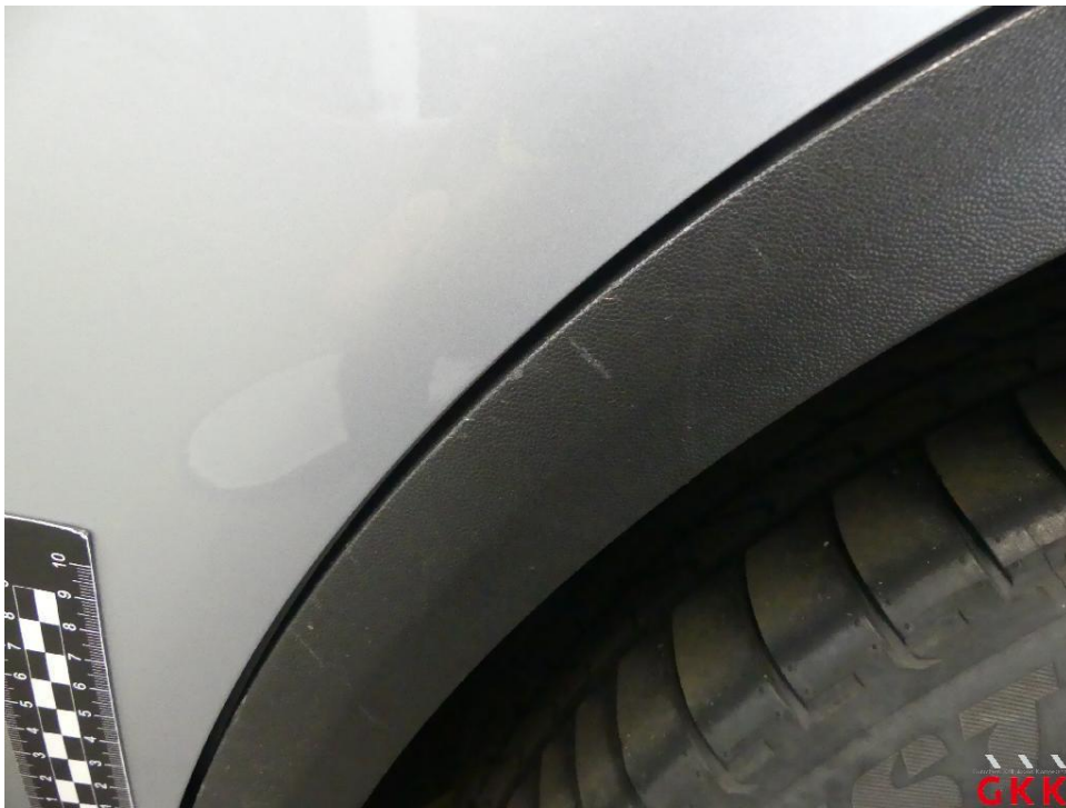
Bild 22 Seitenwand links, Leiste, Radlauf, verkratzt, ersetzen
