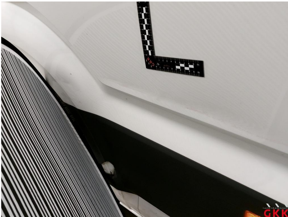
Bild 28 Seitenwand rechts, beschädigt, instand setzen - lackieren
