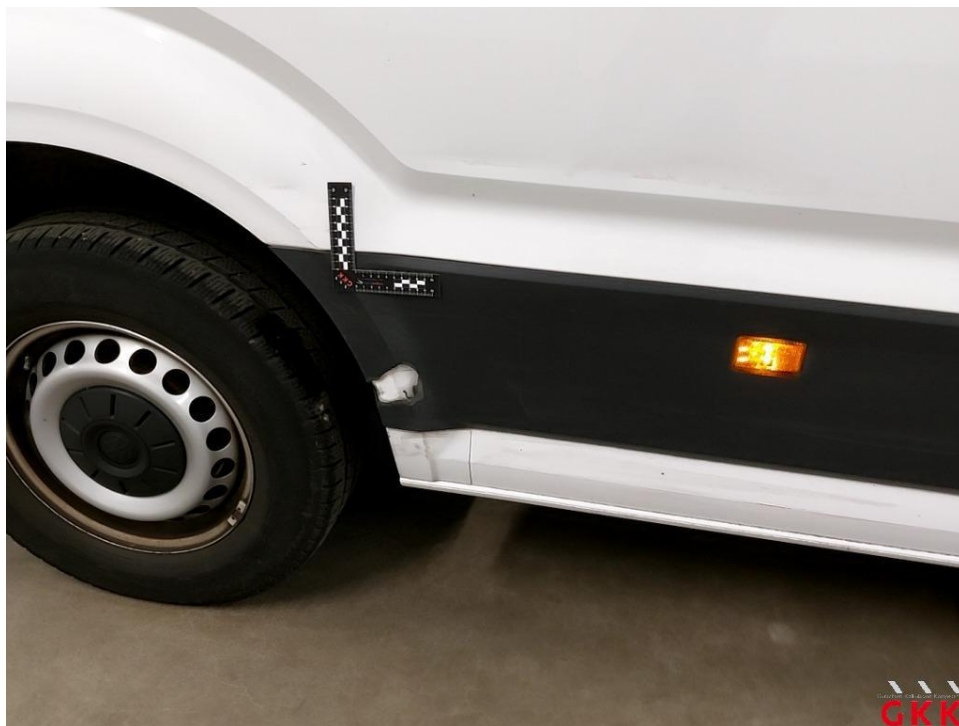
Bild 30 Seitenwand rechts, Leiste -unten-, beschädigt, ersetzen
