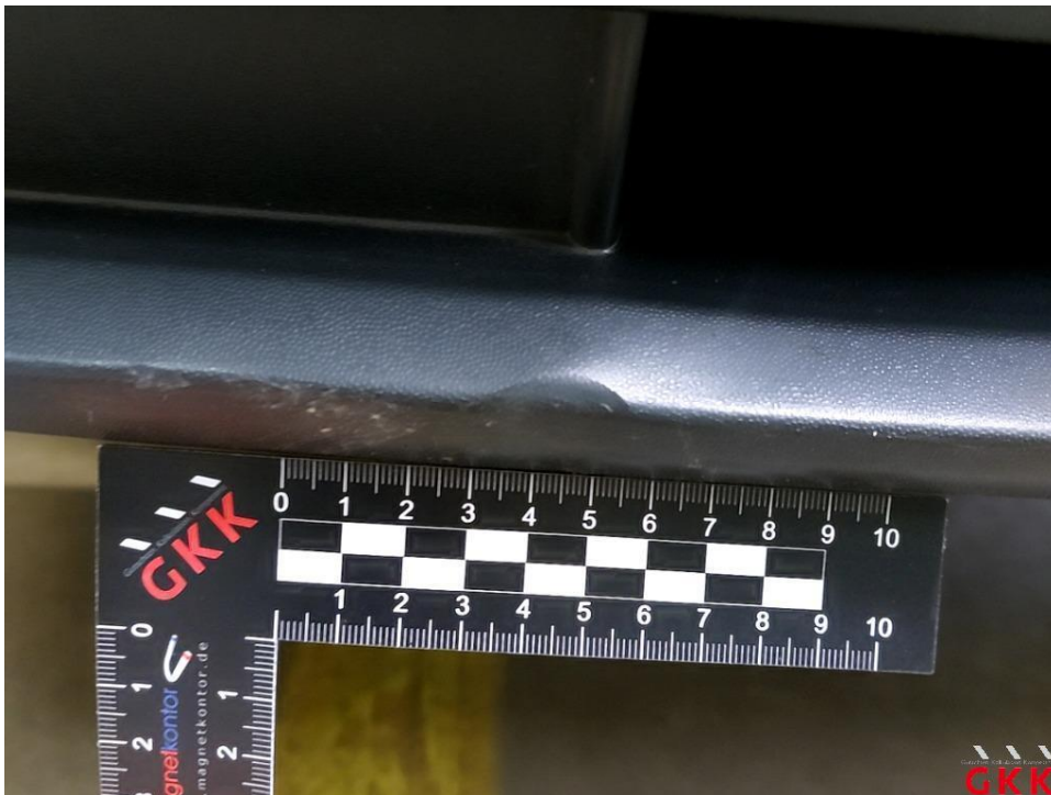
Bild 24 Stoßfänger vorne, Verkleidung -teillackiert-, beschädigt, ersetzen
