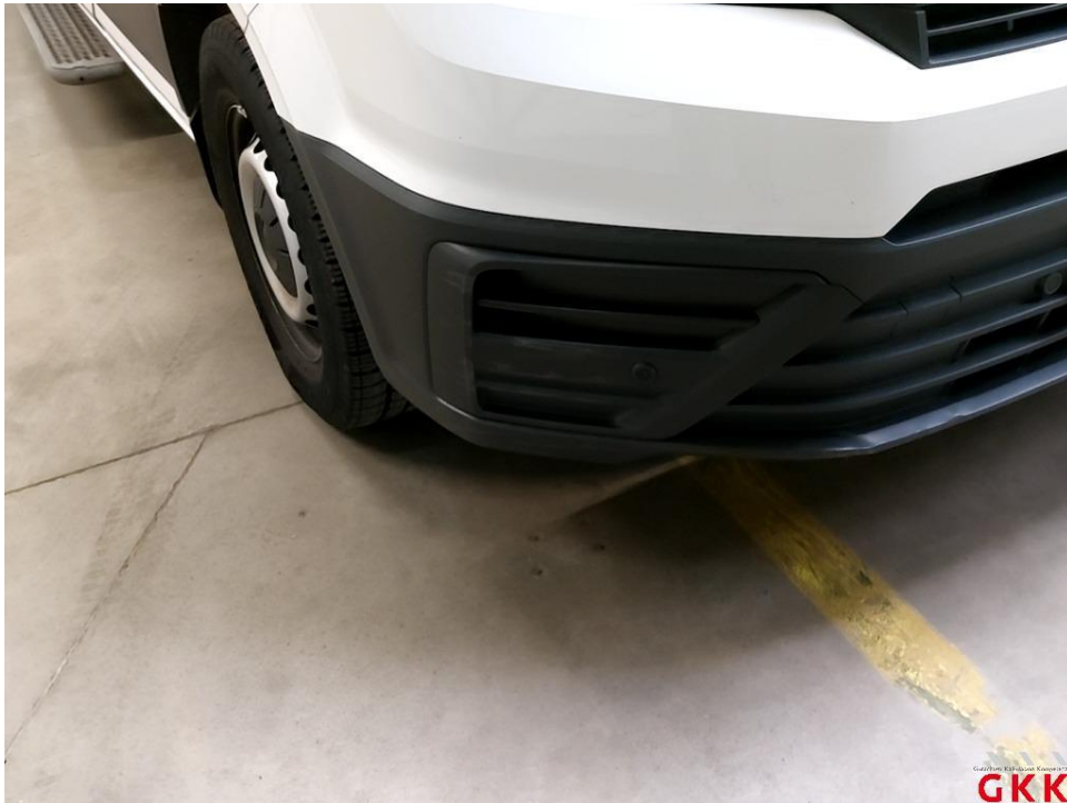
Bild 25 Stoßfänger vorne, Blende -unlackiert-, verkratzt, ersetzen
