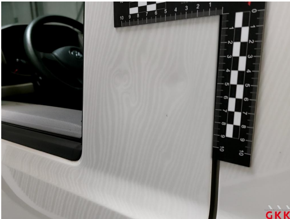
Bild 18 Tür vorne links, beschädigt, instand setzen - lackieren
