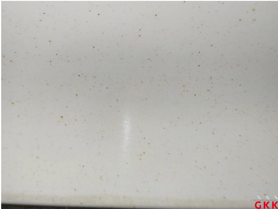
Bild 15 Fahrzeug, außen, Lackierung verwittert / matt, aufbereiten
