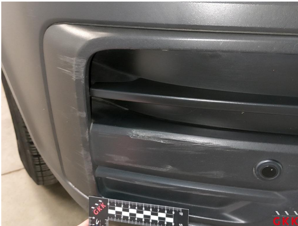
Bild 26 Stoßfänger vorne, Blende -unlackiert-, verkratzt, ersetzen
