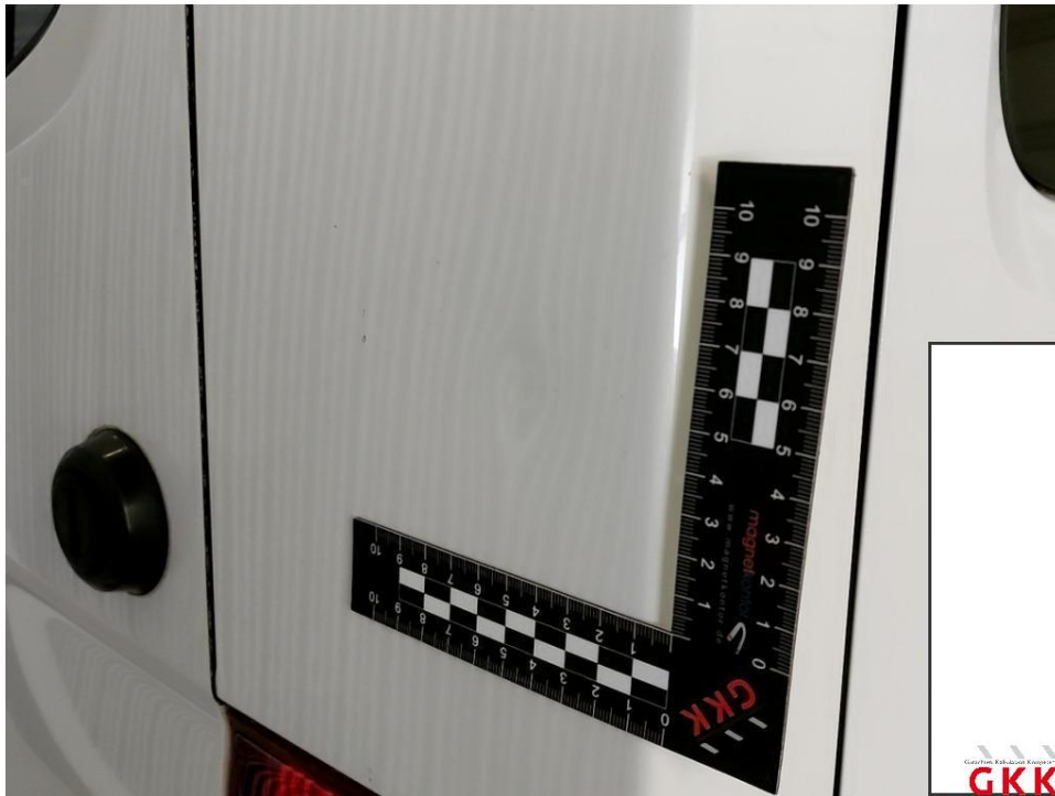
Bild 39 D- Säule links, beschädigt, Smartrepair
