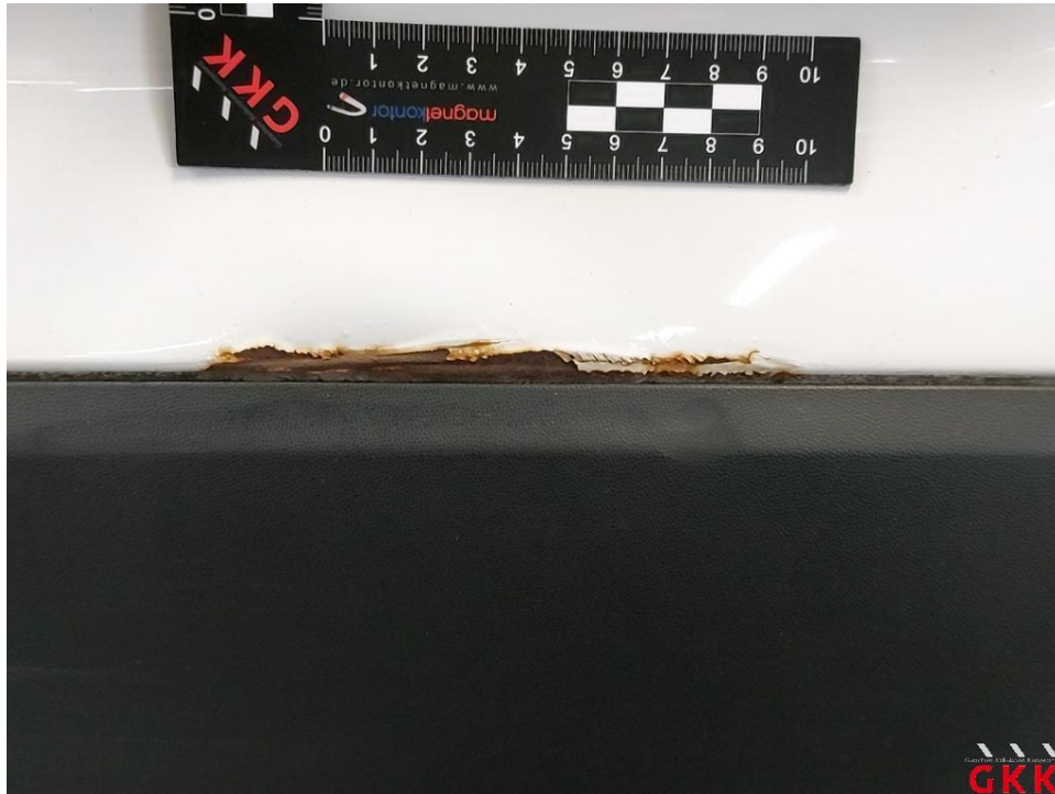
Bild 45 Seitenwand links, beschädigt, instand setzen - lackieren
