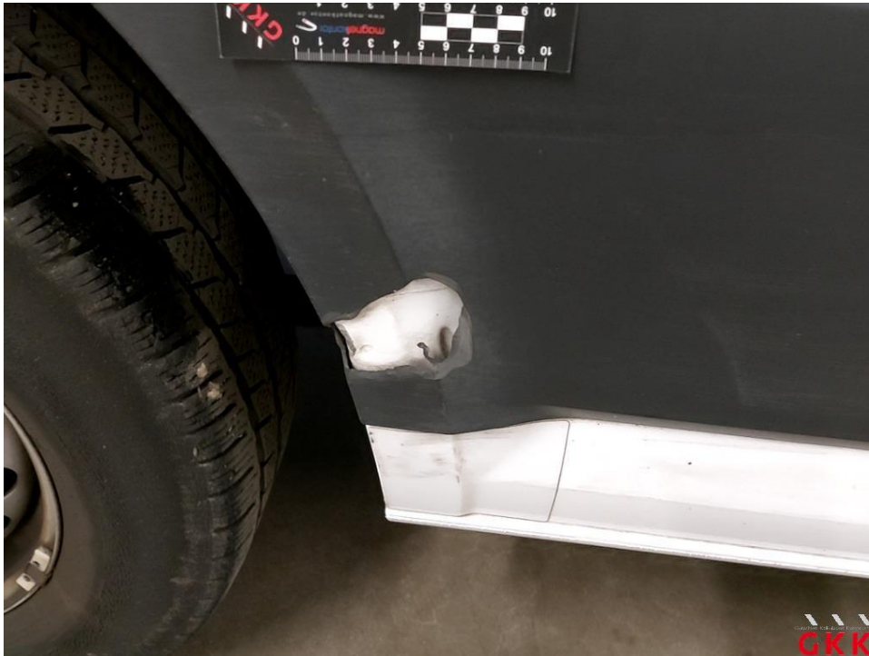
Bild 31 Seitenwand rechts, Leiste -unten-, beschädigt, ersetzen
