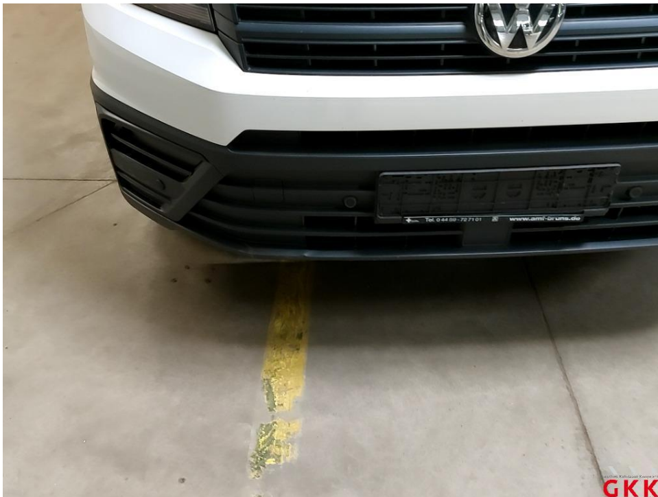
Bild 22 Stoßfänger vorne, Verkleidung -teillackiert-, beschädigt, ersetzen
