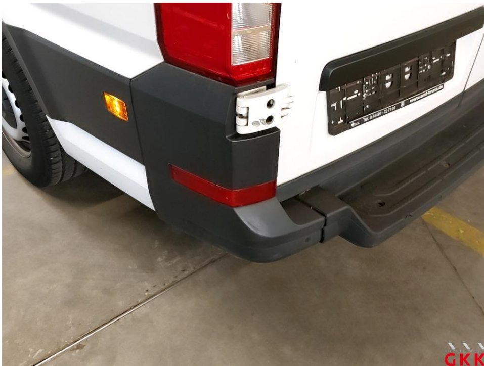
Bild 40 Stoßfänger hinten, Ecke links -unlackiert-, beschädigt, ersetzen
