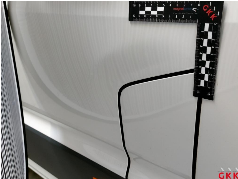
Bild 19 Tür vorne links, beschädigt, instand setzen - lackieren
