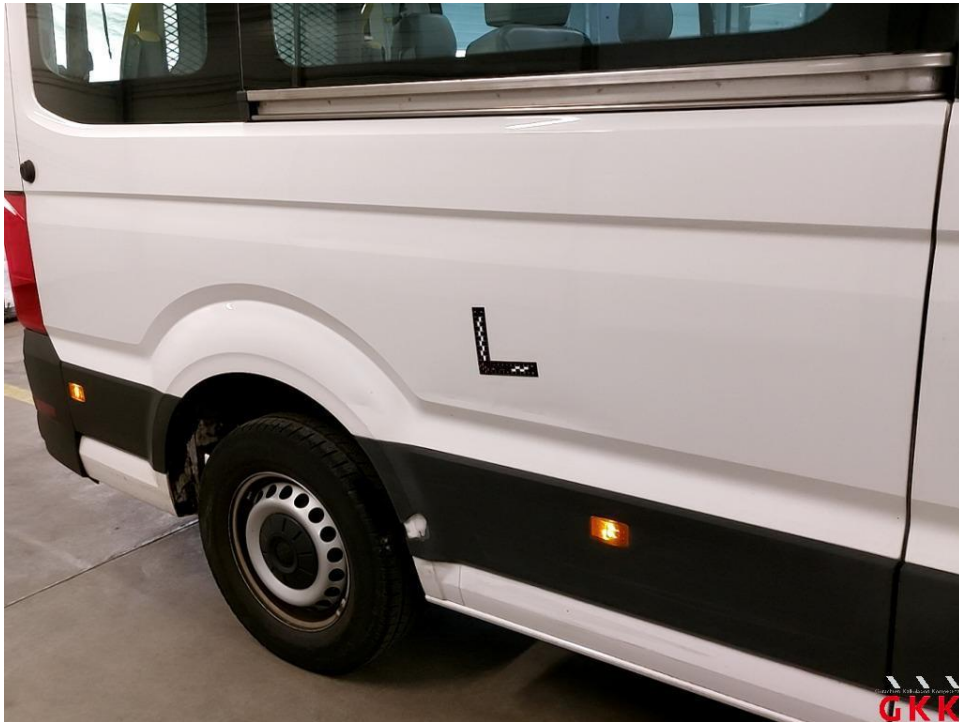
Bild 27 Seitenwand rechts, beschädigt, instand setzen - lackieren
