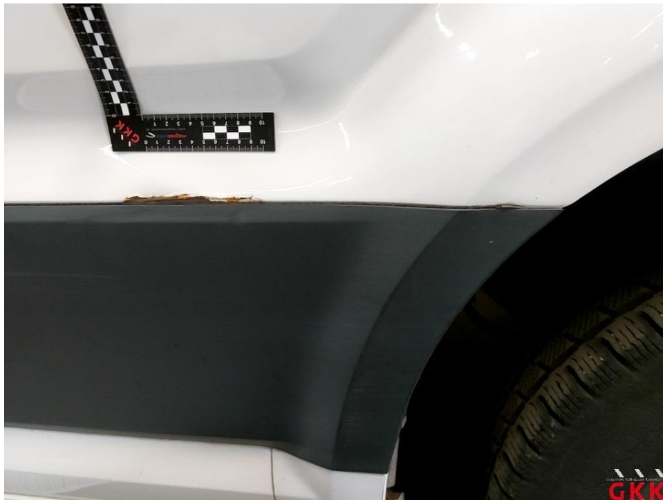
Bild 46 Seitenwand links, Leiste -unten-, beschädigt, ersetzen
