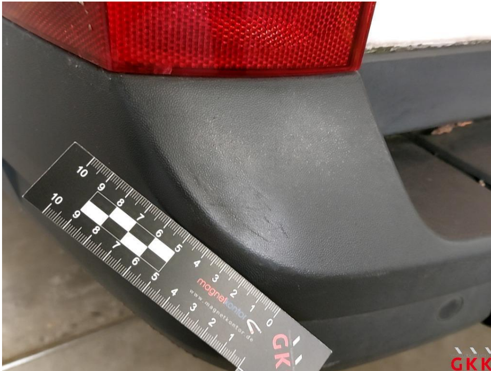
Bild 41 Stoßfänger hinten, Ecke links -unlackiert-, beschädigt, ersetzen
