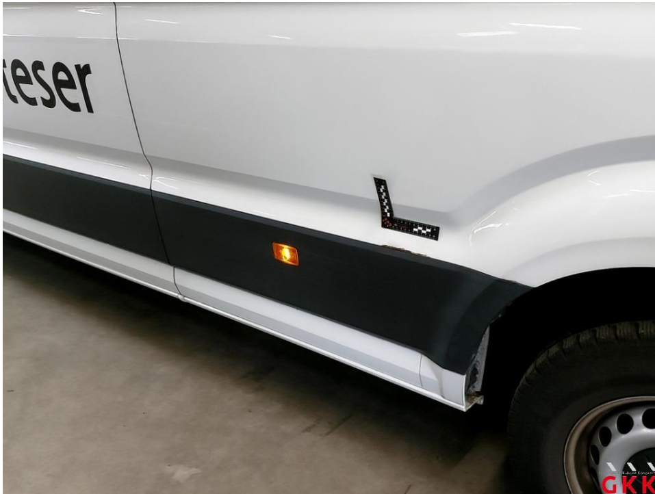
Bild 43 Seitenwand links, beschädigt, instand setzen - lackieren
