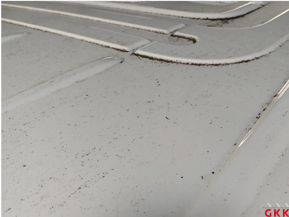
Bild 17 Fahrzeug, außen, Lackierung verwittert / matt, aufbereiten
