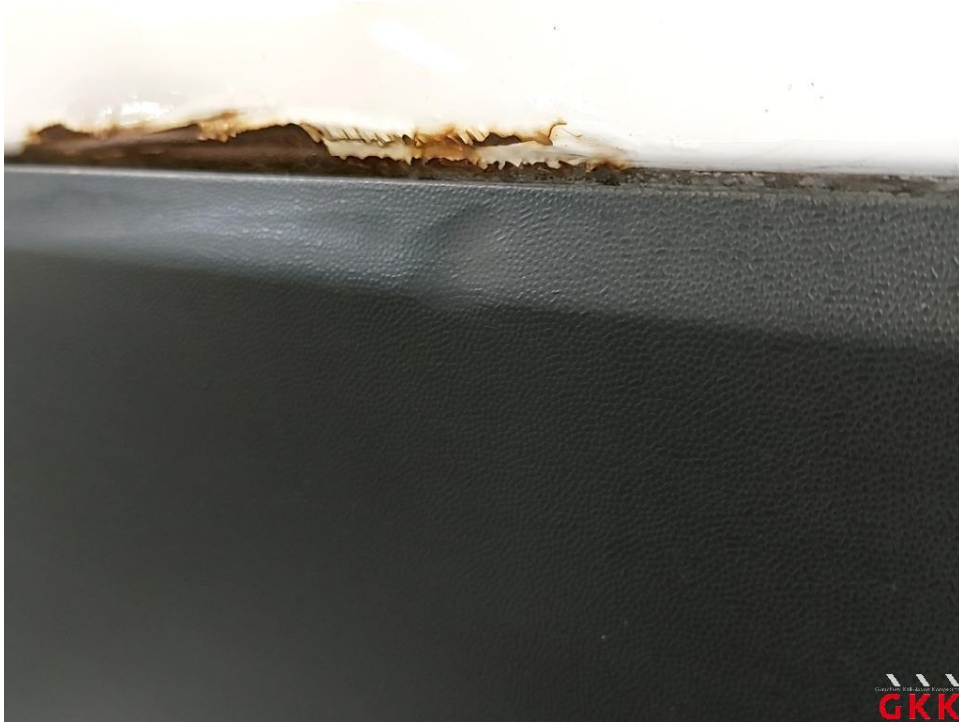
Bild 47 Seitenwand links, Leiste -unten-, beschädigt, ersetzen
