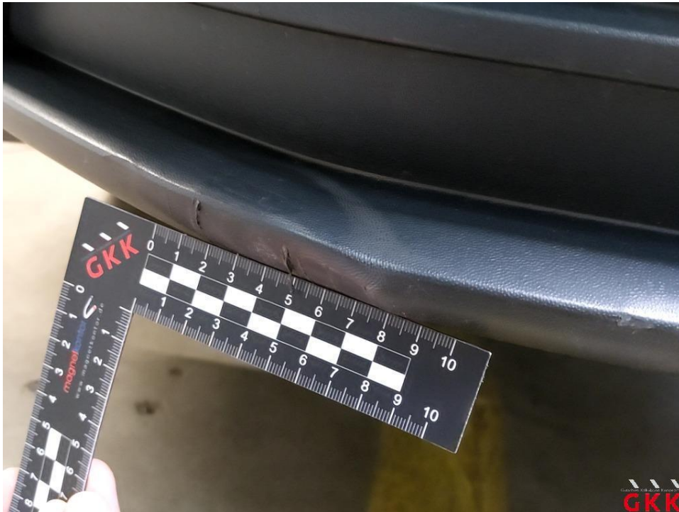
Bild 23 Stoßfänger vorne, Verkleidung -teillackiert-, beschädigt, ersetzen
