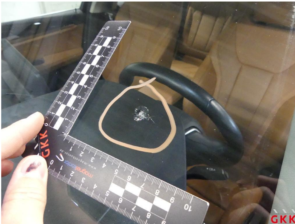
Bild 16 Frontscheibe, mit Regensensor und Frontkamera, Steinschlag mit Rissbildung, ersetzen
