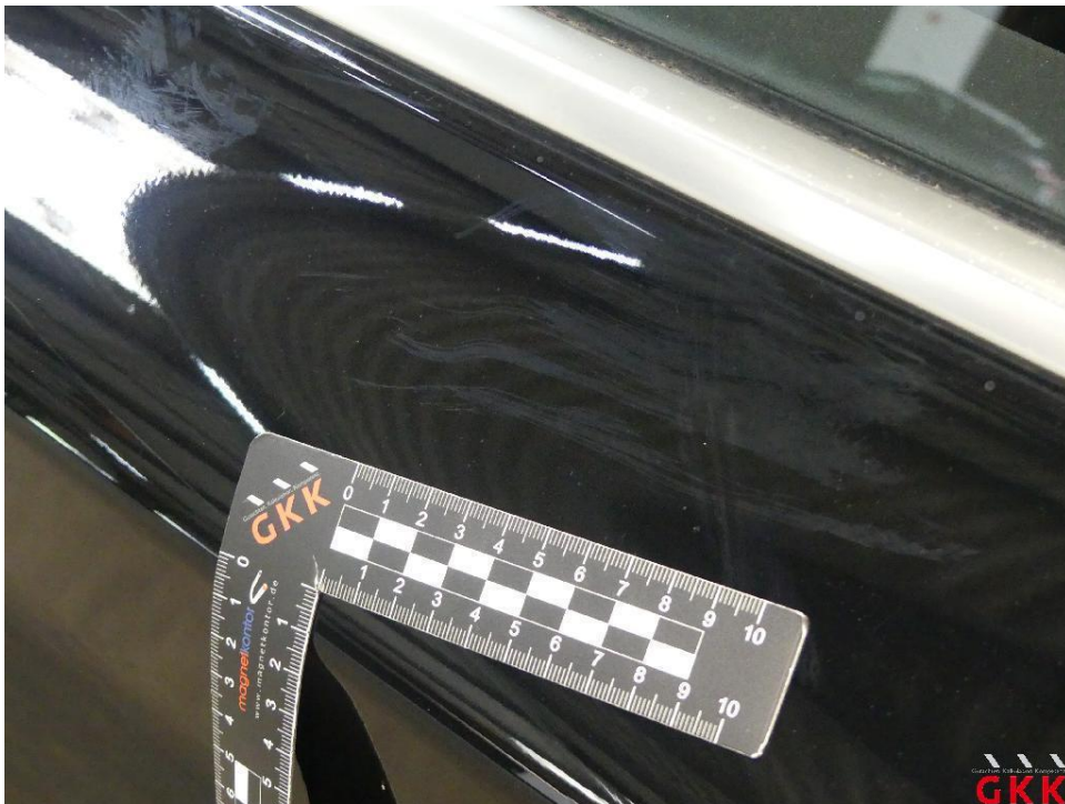
Bild 24 Tür hinten links, Lackierung verwittert / matt, polieren
