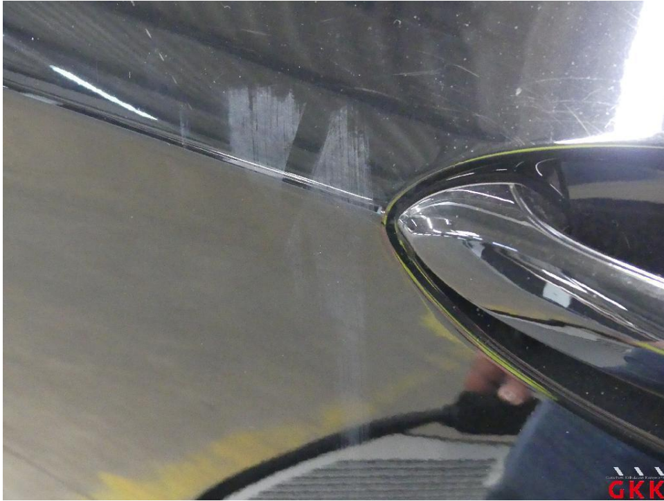
Bild 25 Tür hinten links, Lackierung verwittert / matt, polieren
